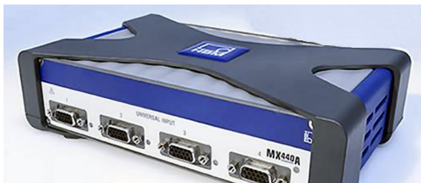
Εικόνα 3.1.3 Αναλογικός-ψηφιακός μετατροπέας (Analog to Digital Converter, ADC) Quantum x MX440A της HBM (Hottinger Baldwin Messtechnik GmbH) τεσσάρων καναλιών για τη λήψη δεδομένων.
