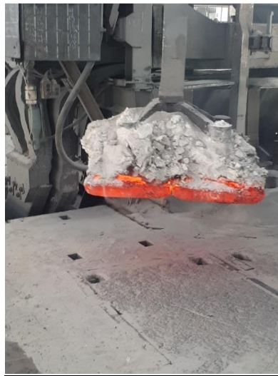
Εικόνα 14 Μέτρια καθαρισμένη άνοδος
