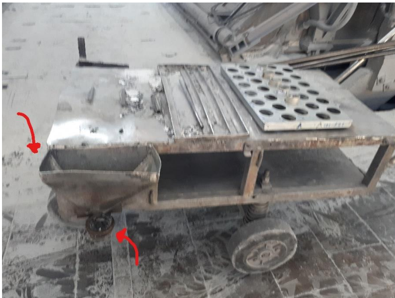
Εικόνα 12 Καρότσι δειγματοληψίας λουτρού όπου διακρίνονται η χοάνη και η θέση όπου τοποθετείται το κύπελο
