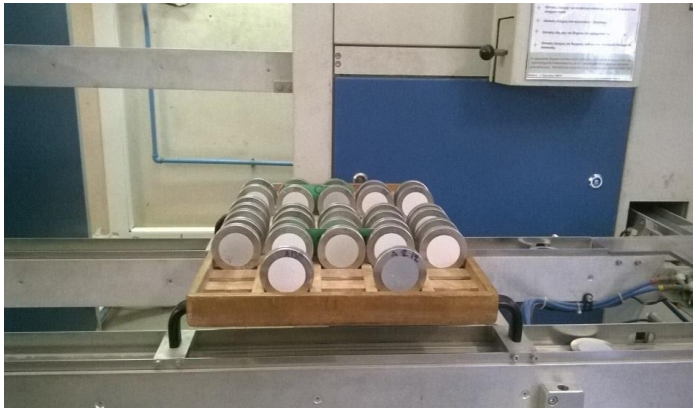
Εικόνα 10 Τάμπλετες λουτρού ηλεκτρόλυσης
