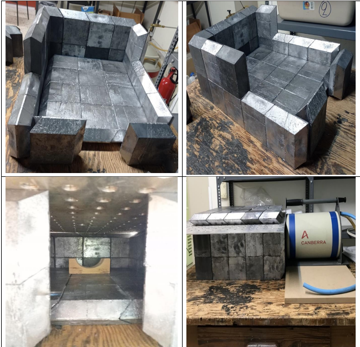
Σχήμα 7.2: Στάδια κατασκευής της θωράκισης του ανιχνευτή BEGe
