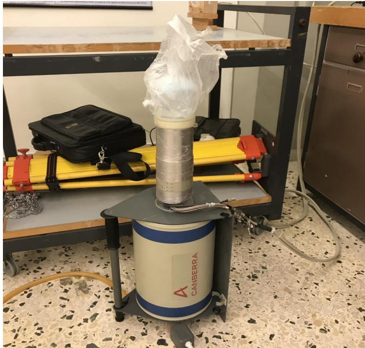
Σχήμα 5.3: Ανιχνευτική διάταξη BEGe – πηγής γεωμετρίας 2 TEL 200403
