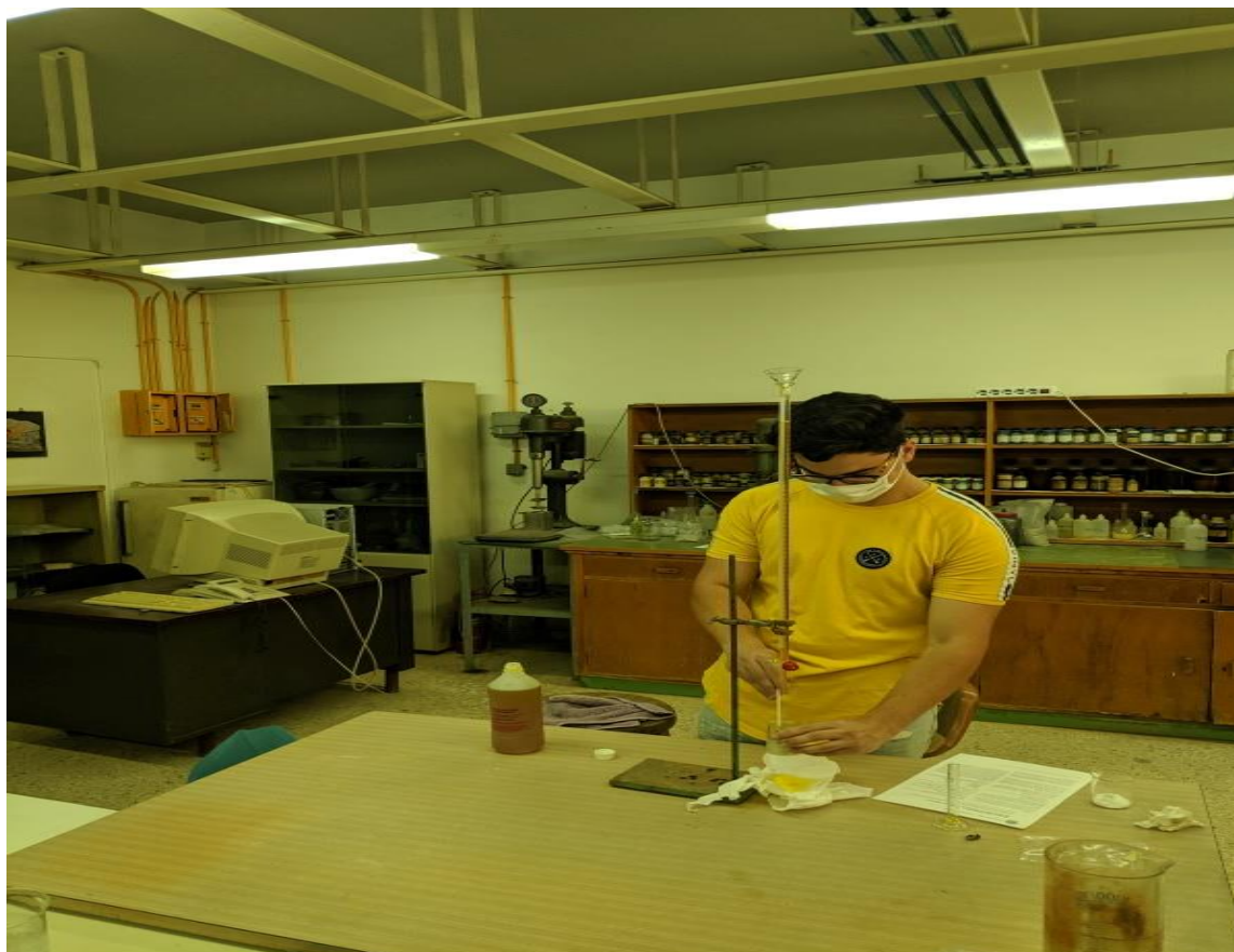
Εικόνα 9-20: Εκτέλεση δοκιμής με την χρήση ωμού λινελαίου και προχοϊδας.
