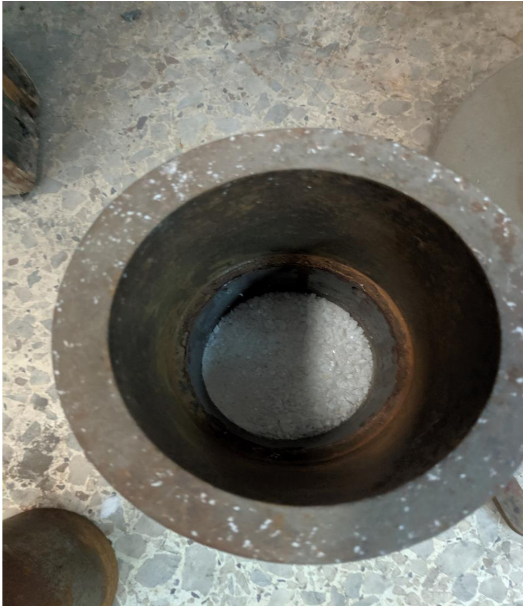
Εικόνα 9-17: Φωτογραφία υλικού έπειτα από τη δοκιμή Protodyakonov
