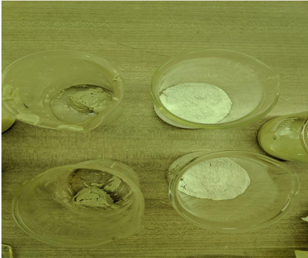
Εικόνα 9-19: Δείγματα μαρμάρου πριν και μετά την πειραματική διαδικασία ελαιοαπορροφητικότητας
