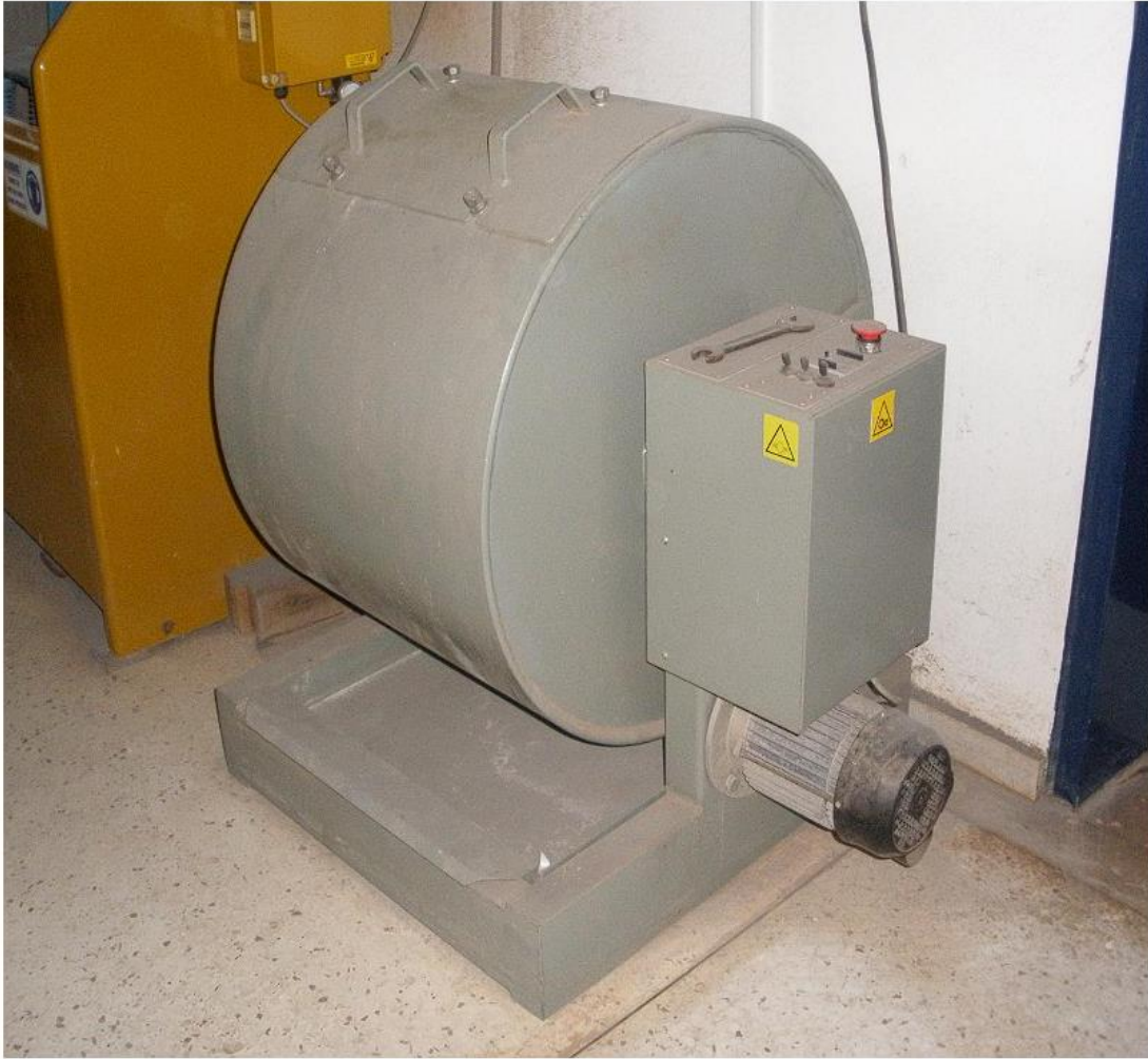
Εικόνα 9-13: Μηχανή Los Angeles, Εργαστήριο Ε.Μ.Π.
