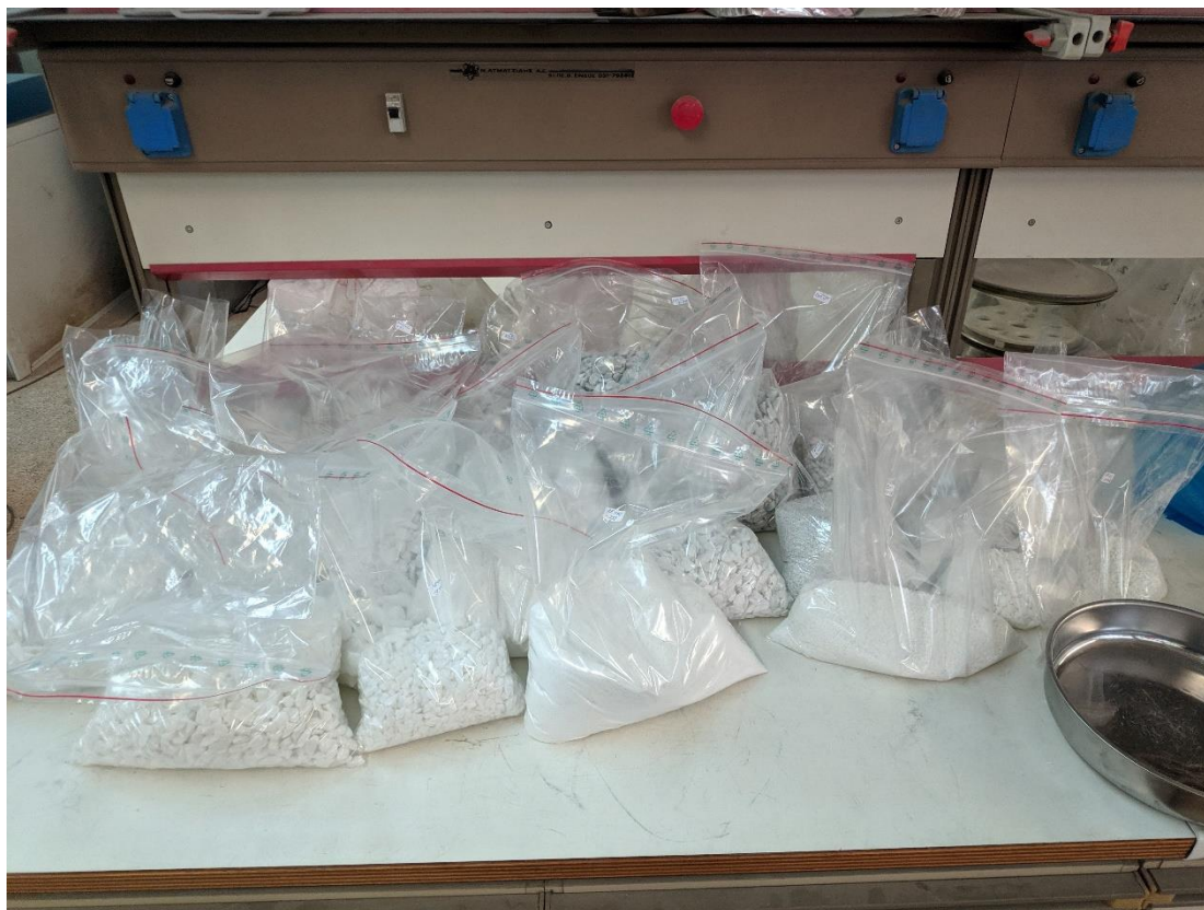
Εικόνα 9-12: Δείγματα χωρισμένα σε κοκκομετρικά κλάσματα (Πίνακες 9-1,9-2,9-3)
