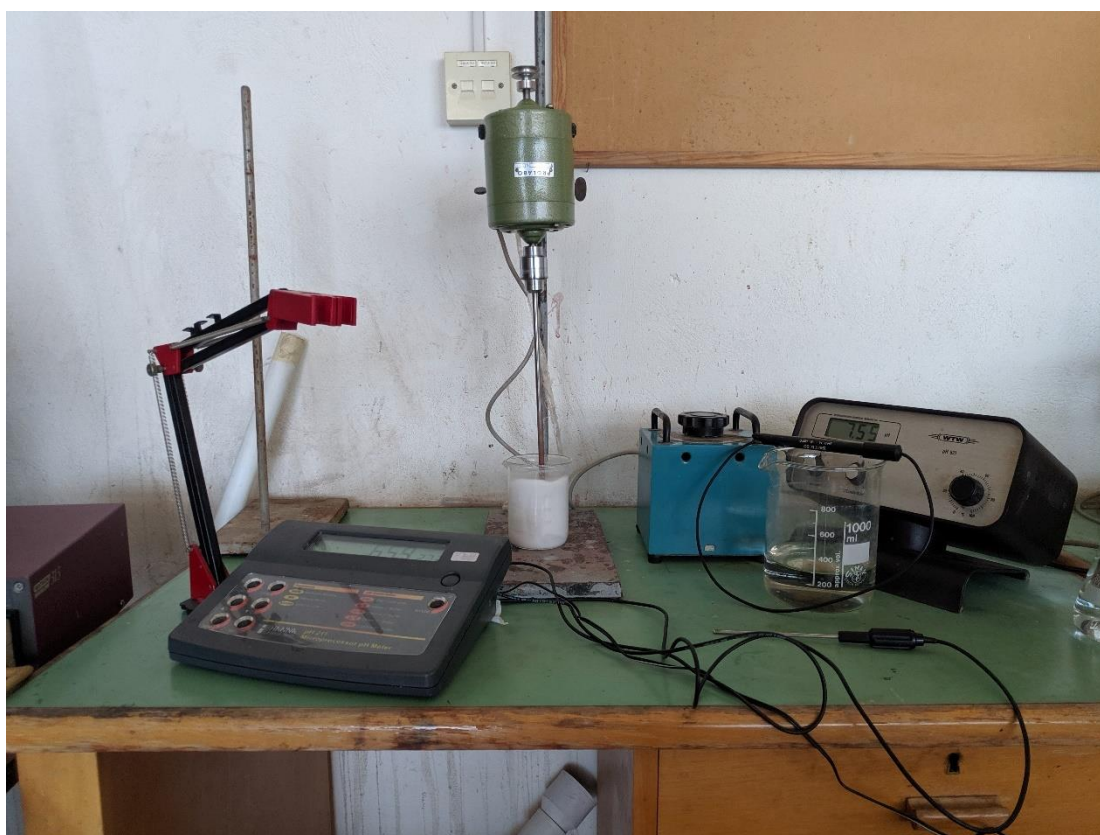
Εικόνα 9-21: Χρήση Πεχάμετρου και Θερμομέτρου για την εκτέλεση της δοκιμής.
