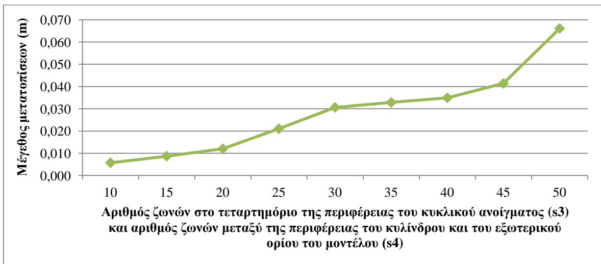
Σχήμα 5.1.2.3 Μεταβολή του μεγέθους των μετατοπίσεων σε σχέση με την τιμή των μεταβλητών s_3 και s_4
