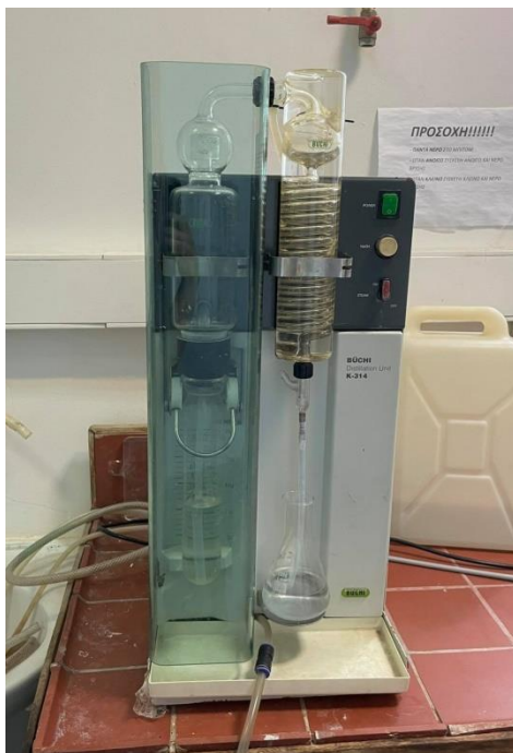
Σχήμα 3.6: Συσκευή απόσταξης τύπου BUCHI 314
