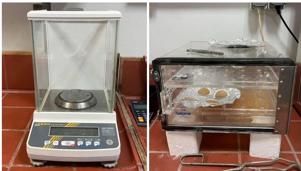
Σχήμα 3.3: Ζυγός ακριβείας (αριστερά) και Αφυγραντήρας (δεξιά)
