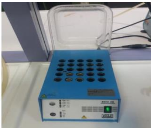
Σχήμα 3.4: Συσκευή χώνευσης φιαλιδίων
