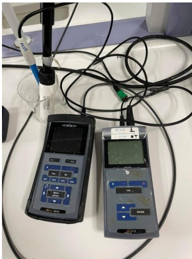
Σχήμα 3.9: Οξυγονόμετρο οχι 330 (αριστερά) και pHμετρο 3110 (δεξιά)
