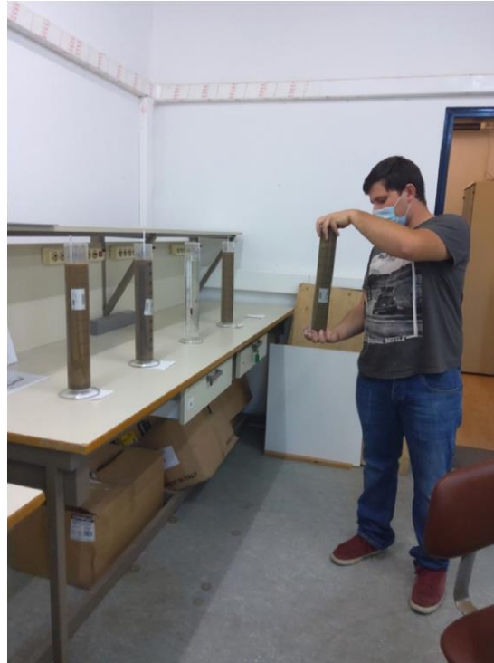
Εικόνα 4-10: Ανατάραξη ογκομετρικού σωλήνα και δείγματα κατά την πορεία των μετρήσεων με το αραιόμετρο.
