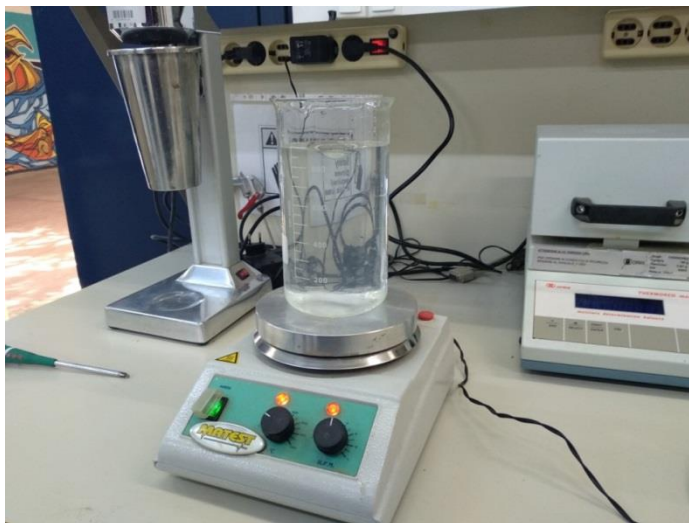
Εικόνα 4-8: Παρασκευή διαλύματος πολυφωσφορικού νατρίου και συσκευή μηχανικής αναδεύσεως (αριστερά).
