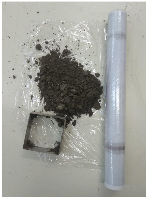
Εικόνα 4-14: Προσπάθεια διαμόρφωσης δείγματος για την δοκιμή άμεσης διάτμησης στο δείγμα 9.
