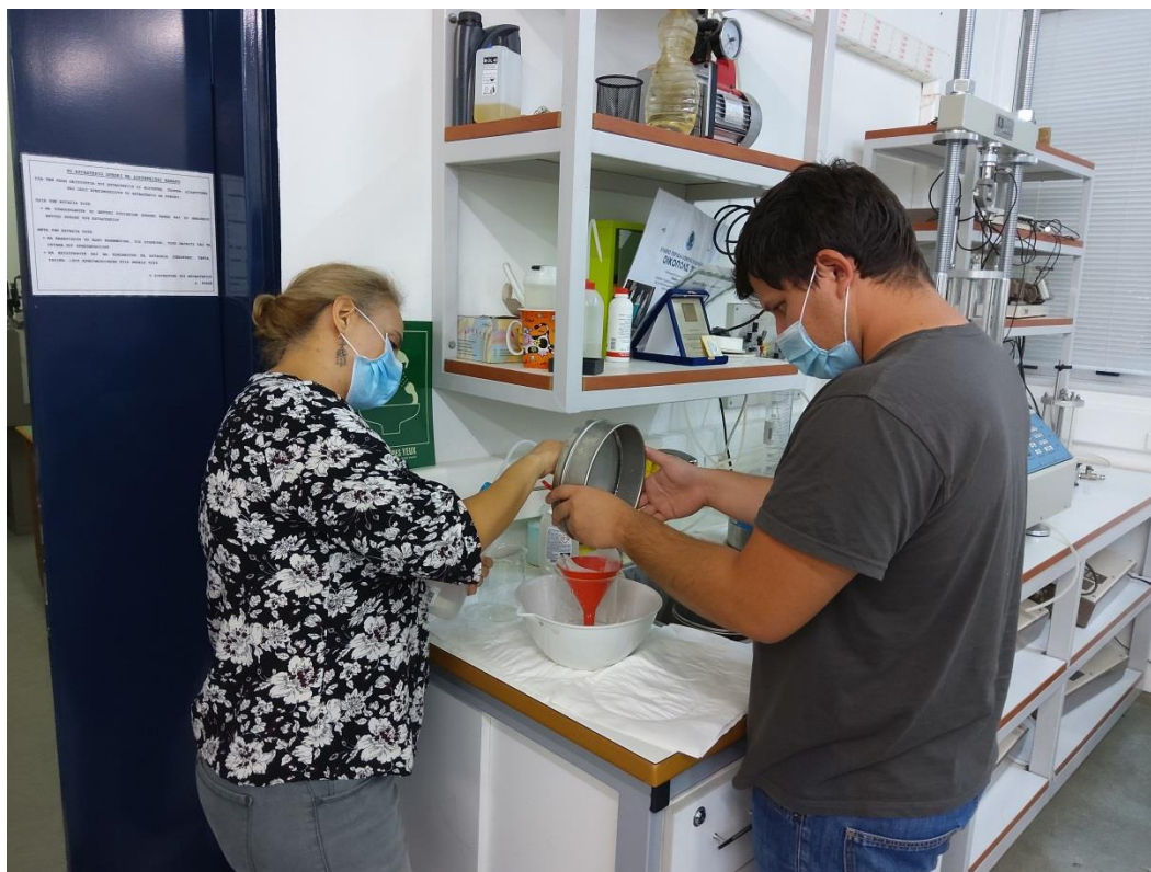
Εικόνα 4-11: Υγρή κοσκίνιση του αιωρήματος από την ανάλυση ιλύος.
