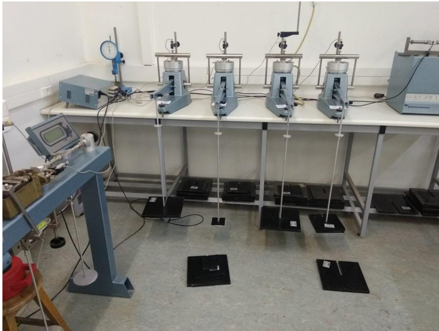
Εικόνα 4-18: Διάταξη εργαστηριακού εξοπλισμού για την δοκιμή μονοδιάστατης στερεοποίησης.
