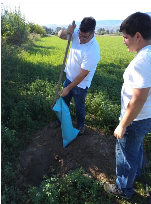
Εικόνα 3-7: Λήψη διαταραγμένου δείγματος από θέση δειγματοληψίας.
