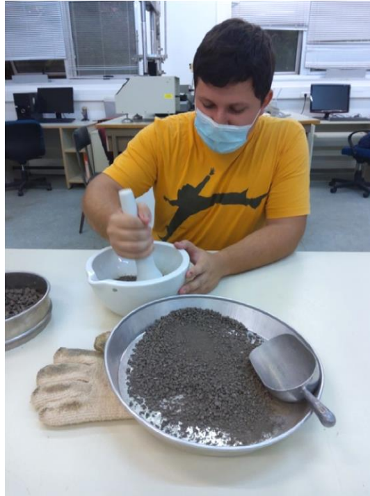
Εικόνα 4-6 Κονιοποίηση ξηρού υλικού με την χρήση γουδιού.
