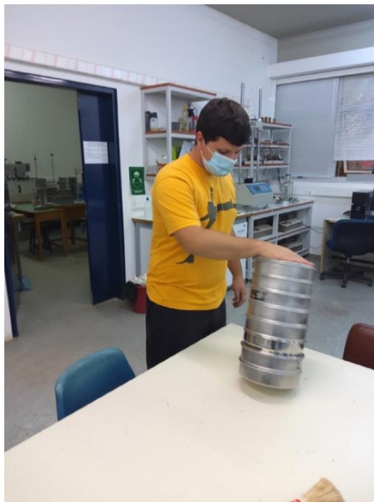
Εικόνα 4-7: Κοσκίνιση δείγματος για κοκομετρική ανάλυση.
