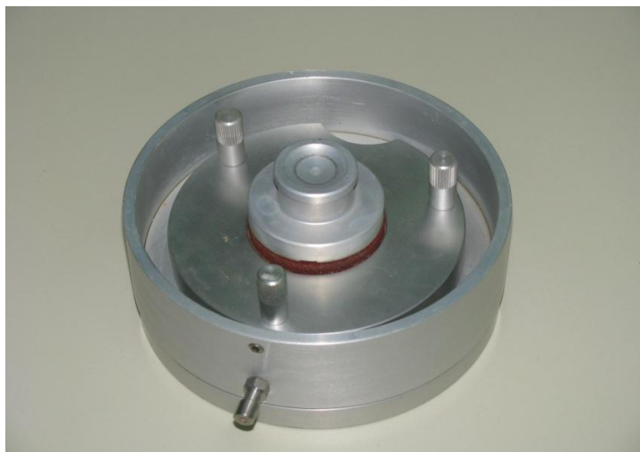
Εικόνα 4-20: Συσκευή στερεοποίησης μαζί με εδαφικό δείγμα.
