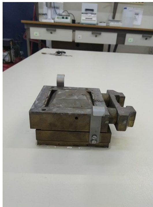
Εικόνα 4-16: Δοκίμιο μετά την δοκιμή άμεσης διάτμησης .Φαίνεται ότι η μετακίνηση επιβάλλεται στο πάνω μέρος της διάταξης.
