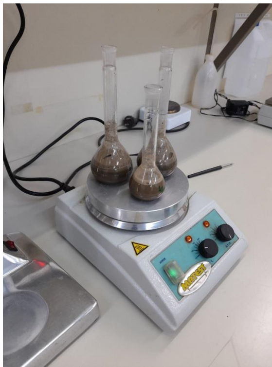
Εικόνα 4-1: Επιβολή βρασμού στο δείγμα με σκοπό την απομάκρυνση του αέρα που έχει παγιδευτεί.
