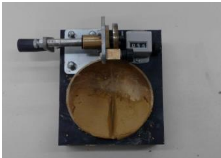
Εικόνα 4-3: Κλείσιμο χαραγής στη συσκευή Casagrande.
