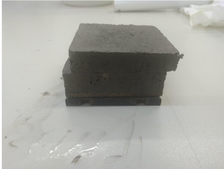
Εικόνα 4-17: Δοκίμιο μετά την δοκιμή άμεσης διάτμησης. Φαίνεται η επιφάνεια διάτμησης.
