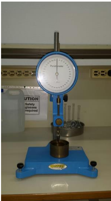
Εικόνα 4-4: Συσκευή δοκιμής πεντρομέτρου πίπτοντος κώνου.
