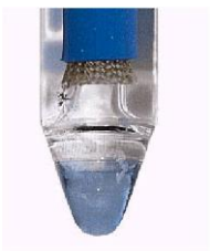
Σχήμα 2.4 Δομή μεμβράνης ηλεκτροδίου pH ( Τεχνικό εγχειρίδιο χρήσης & εφαρμογής αισθητήρα εταιρείας WTW – Xylem Analytics GmbH )
