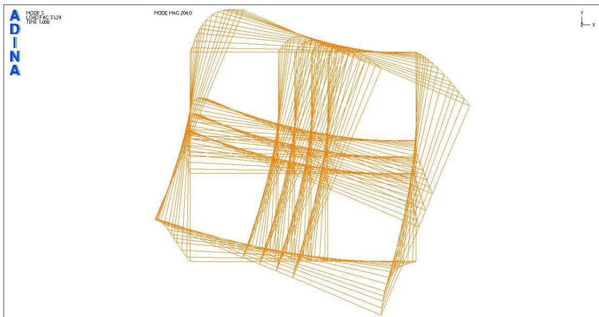
Σχήμα 3.56: 3 η ιδιομορφή λυγισμού , κάτοψη
