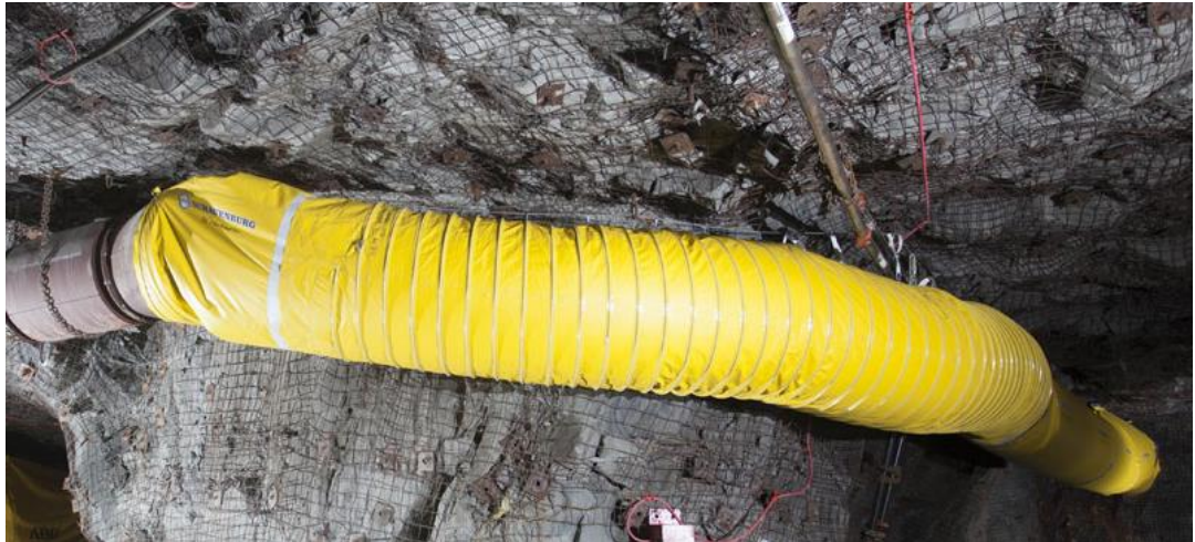
Εικόνα 2.18 : Εύκαμπτος αγωγός με σπειροειδή ελατήριο
