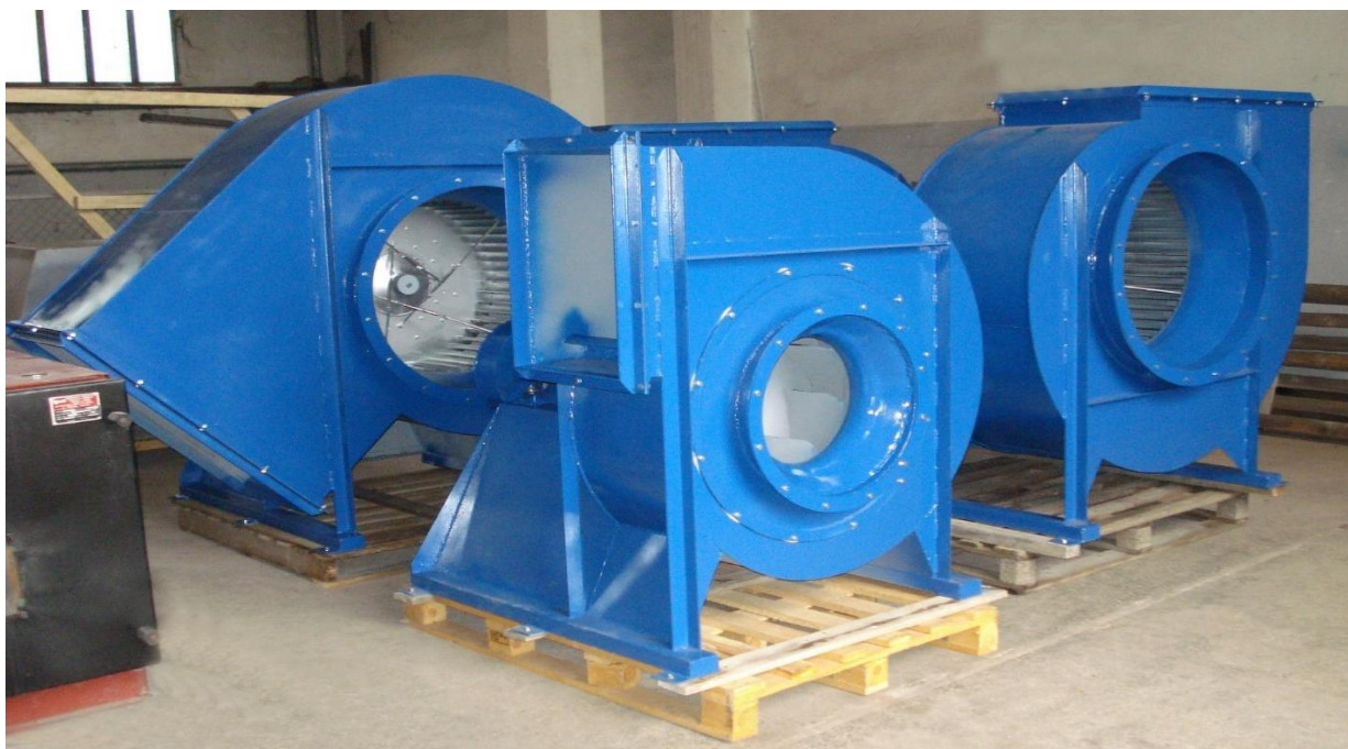
Εικόνα 2.5 : Φυγόκεντρικοί ανεμιστήρες σε μεταλλείο στο Μαντούδι Ευβοίας ("ΤΕΡΝΑ ΛΕΥΚΟΛΙΘΟΙ Α.Ε")
