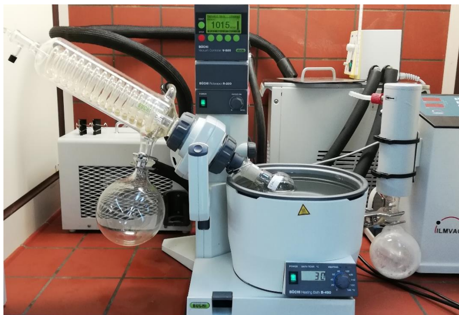
Εικόνα 22: Περιστρεφόμενος εξατμιστήρας (BUCHI Rotavapor R-200) συζευγμένος με αντλία κενού (BUCHI Vacuum Controller V-800).
