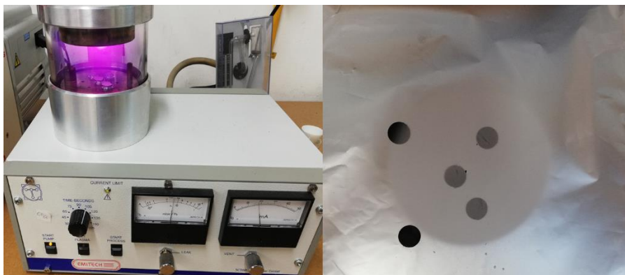
Εικόνα 37 :Αριστερά: Συσκευή επιχρύσωσης (SC7620 Mini Sputter Coater, Quorum Technologies), Δεξιά: Συλλογή δείγματος στο αλουμινόχαρτο πάνω στο οποίο έχουν τοποθετηθεί δειγματοφορείς.
