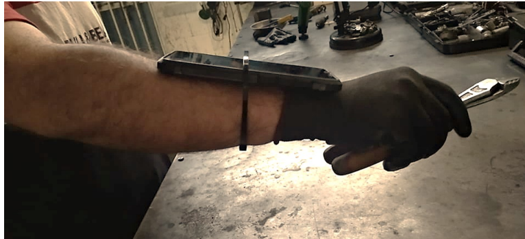
Σχήμα 6.1: Προσάρτηση smartphone στον καρπό των 2 χειριστών για τη διεξαγωγή των 5 κινήσεων.
