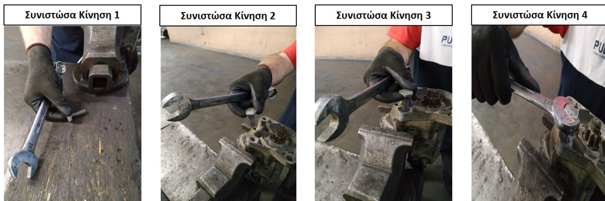
Σχήμα 6.2: Παρουσίαση 4 φάσεων κατά την εκτέλεση του βιδώματος με χρήση γερμανικού κλειδιού.
