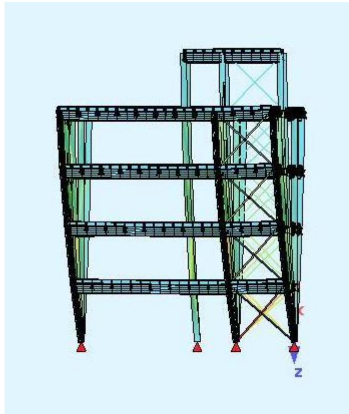
Εικόνα 7.4: 2 η ιδιομορφή σε όψη (άξονες y-z) κτίριο με κανονικότητα χωρίς ικανοποιητική συμπεριφορά
