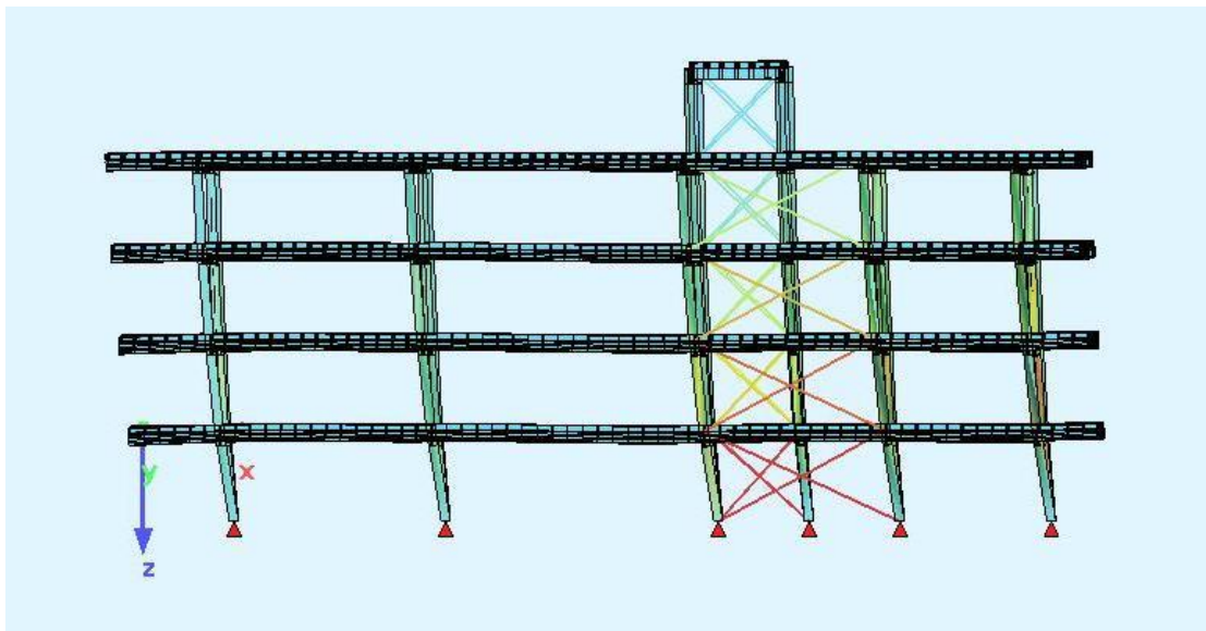
Εικόνα 7.5: 2 η ιδιομορφή σε όψη (άξονες x-z) κτίριο με κανονικότητα χωρίς ικανοποιητική συμπεριφορά
