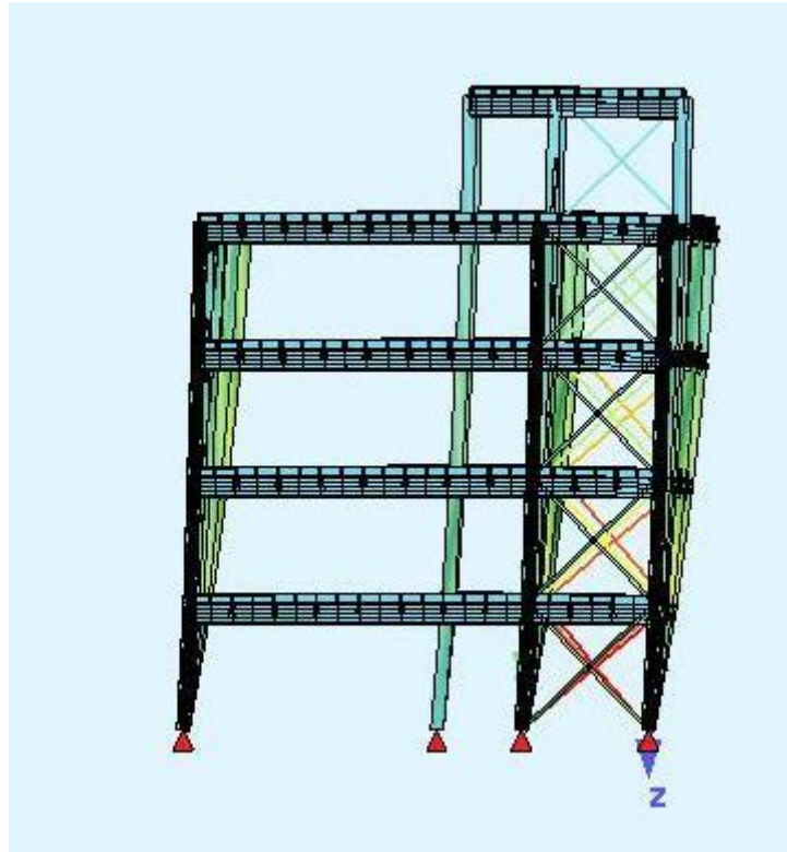
Εικόνα 7.2: 1 η ιδιομορφή σε όψη (άξονες y-z) κτίριο με κανονικότητα χωρίς ικανοποιητική συμπεριφορά
