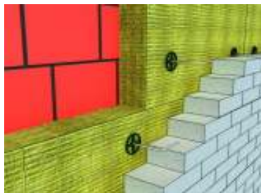
Εικόνα 4.7: Μόνωση διπλού εξωτερικού τοίχου με πετροβάμβακα ( http://www.knaufinsulation.gr/files/ki_gr/upload/1senwich.jpg )
