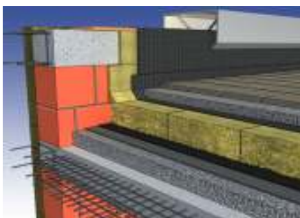
Εικόνα 4.10: Επισκέψιμη κατασκευή με τελικό στρώμα, γέμισμα ελαφρομπετού κλίσης, αδιάβροχη μεμβράνη, πετροβάμβακα δωμαίων, φράγμα ατμών, στρώμα εξισορρόπησης της τάσης υδρατμών και πλάκα από μπετό ( http://www.knaufinsulation.gr/files/ki_gr/upload/prohodniKR.png )
