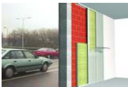
Εικόνα 4.6: Μόνωση των εξωτερικών τοίχων από μέσα ( http://www.knaufinsulation.gr/files/ki_gr/upload/ka_spolja_saobracaj.jpg )
