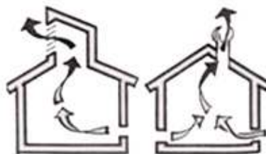
Εικόνα 3.7 Καμινάδα αερισμού και πύργος αερισμού
