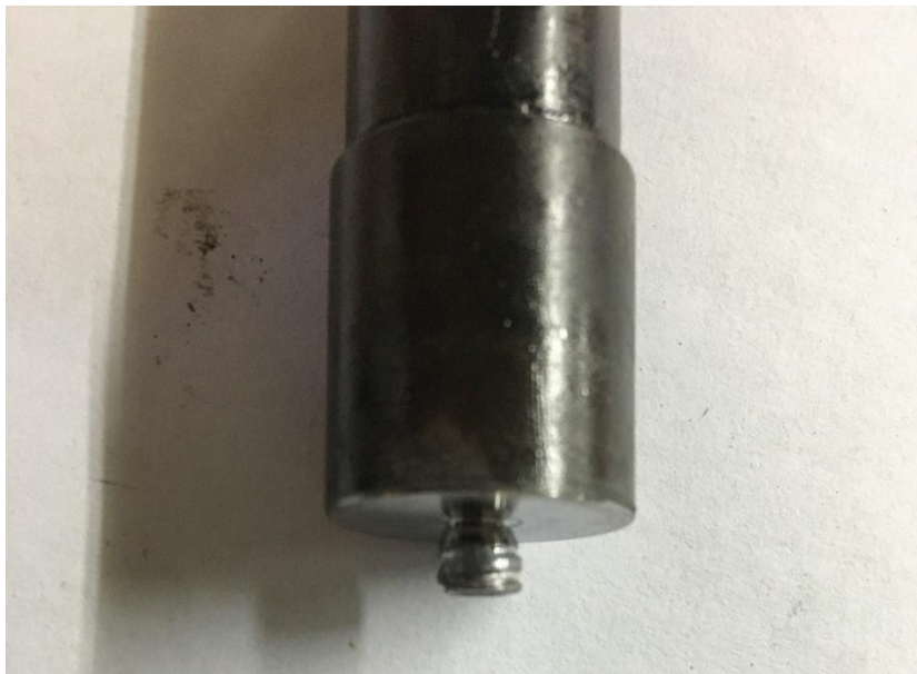
Εικόνα 14 Εργαλείο 2 (Επεξεργασία του εργαλείου 1 με μείωση της διαμέτρου του πείρου στα 4.5mm με ύψος λαιμού 1.8mm)
