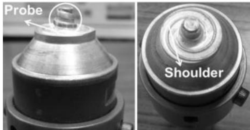
Εικόνα 9 Εργαλείο που χρησιμοποιήθηκε στην πειραματική διεργασία FSC για το υλικό AA5083-H111
