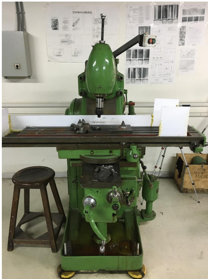
Εικόνα 12 Φραιζομηχανή τύπου Kearney & Trecker Milwaukee
