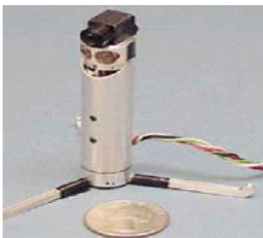
Εικόνα 3.8-2: Μικρο-ρομπότ που εισέρχονται στη στομαχική κοιλότητα κατά τη διάρκεια μίας επέμβασης
