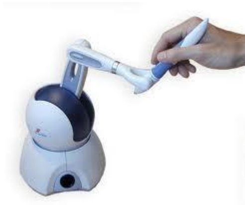
Εικόνα 2.5-4 : Παροχή ανάδρασης δύναμης με τη βοήθεια του Phantom
