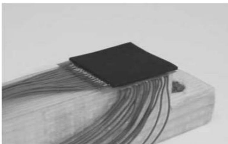
Εικόνα 4.12-1 : Αισθητήρας αφής με πιεζο-ανθεκτικό λάστιχο
