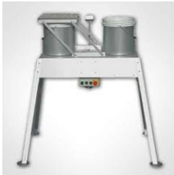
Σχήμα 3.9: Φωτογραφία του μοντέλου ARS 1010 της εταιρείας ATX. Πρόκειται για μία συσκευή συλλογής δειγμάτων ατμοσφαιρικής απόθεσης deposition sampler (ATX Company, Italy).
