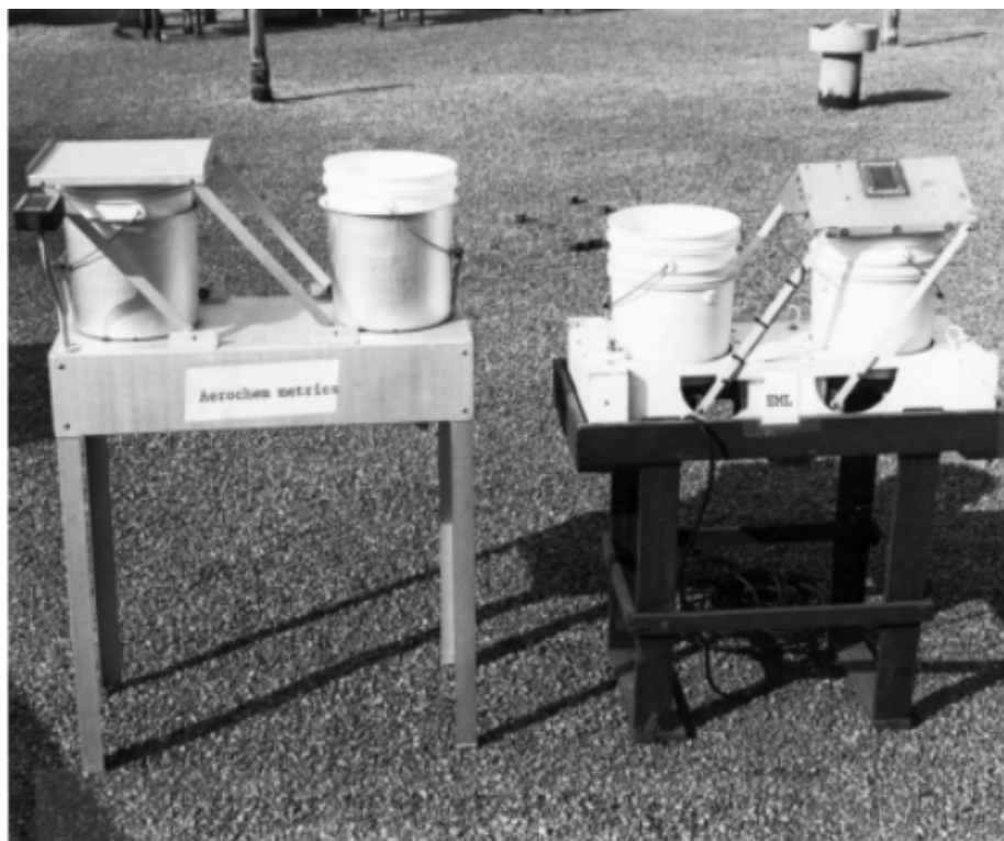
Σχήμα 3.7: Φωτογραφία από τους συλλέκτες ξηρής και υγρής απόθεσης του EML (Erickson and Chieco, 1997).
