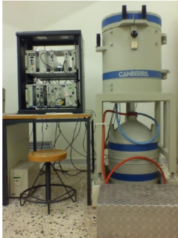
Σχήμα 4.8: Φωτογραφία του ανιχνευτή XtRa του ΕΠΤ-ΕΜΠ με εγκατεστημένο το CSS.
