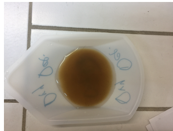
(δ') Το ίζημα ρητίνης, το οποίο συλλέχθηκε μετά το πέρας του φιλτραρίσματος.
