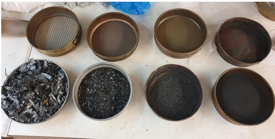
Εικόνα 6.7. Τα 4 δείγματα του υλικού με το αντίστοιχο κόσκινο πάνω από το καθένα ξεκινώντας από αριστερά προς τα δεξιά από +5,6mm έως -0,5mm
