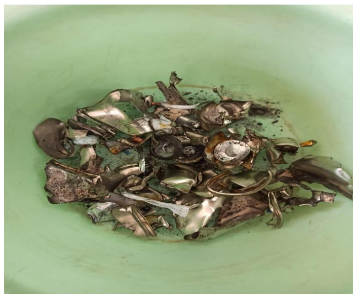
Εικόνα 6.5. Μεταλλικά κελύφη και πλαστικά μετά τη χειροδιαλογή
