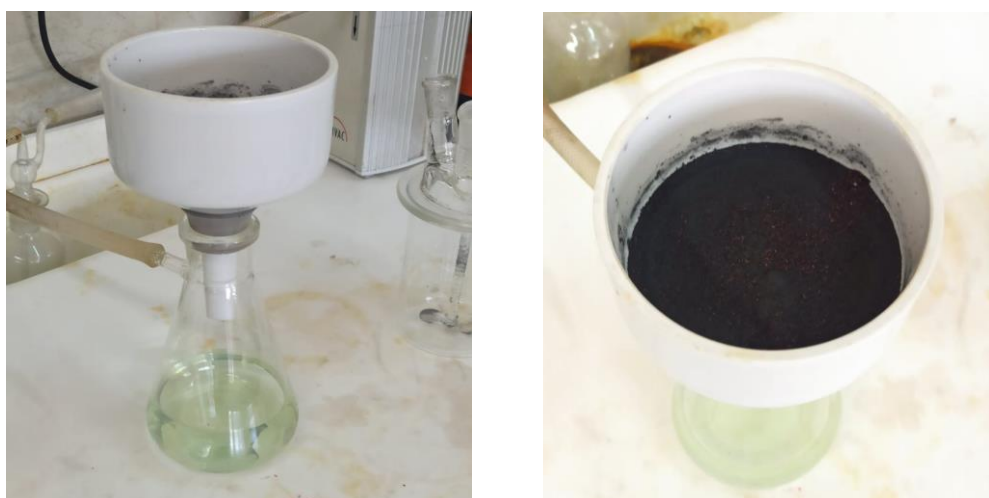
Εικόνα 6.12. Διάταξη διήθησης και διήθημα
