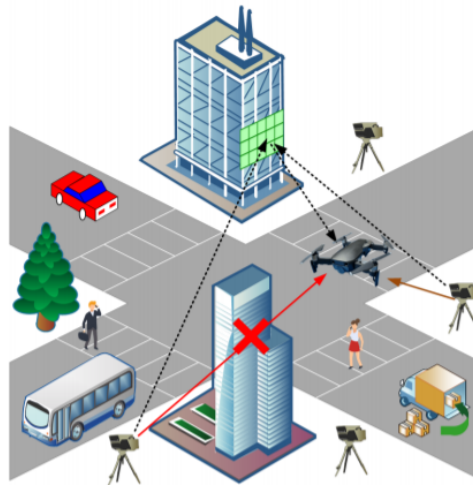
Σχήμα 2.4: UAV-επικοινωνίες υποβοηθούμενες από το RIS. Πηγή Αναφοράς: [4]
