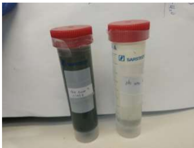
Εικόνα 42 Νανοσωματίδια Mo που παρασκευάστηκαν υπό ατμόσφαιρα αζώτου (αριστερά) και αέρα (δεξιά)
