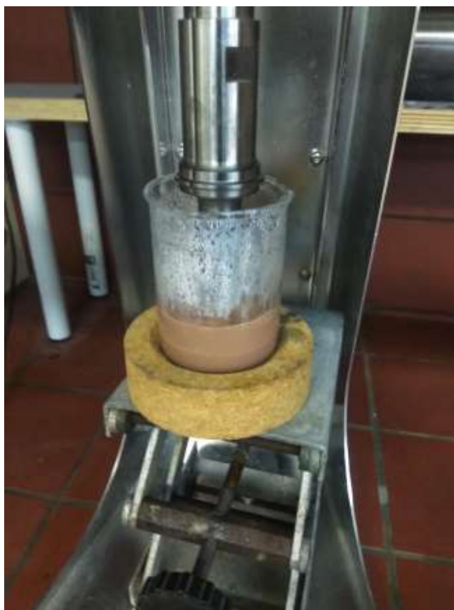
Εικόνα 34. Ηχοχημική παρασκευή νανοσωματιδίων χαλκού και εναπόθεσή τους σε αλούμινα, με ηχοχημική μέθοδο
