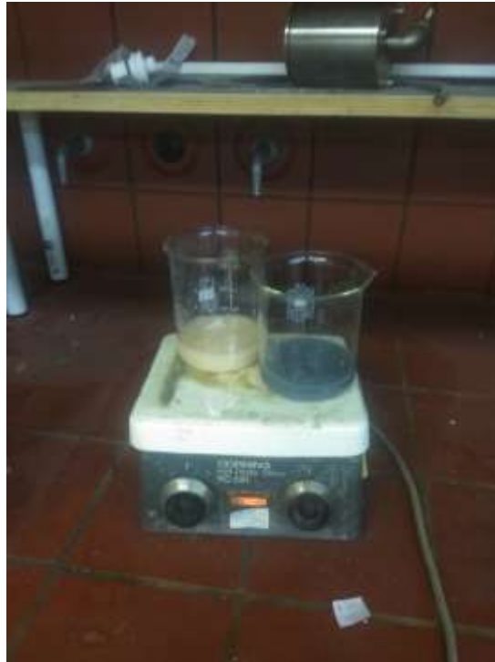
Εικόνα 30. Αριστερά Mo σε αλούμινα , δεξιά Cu-Mo σε αλουμινα, με την μέθοδο υγρού εμποτισμού, σε t=0h
