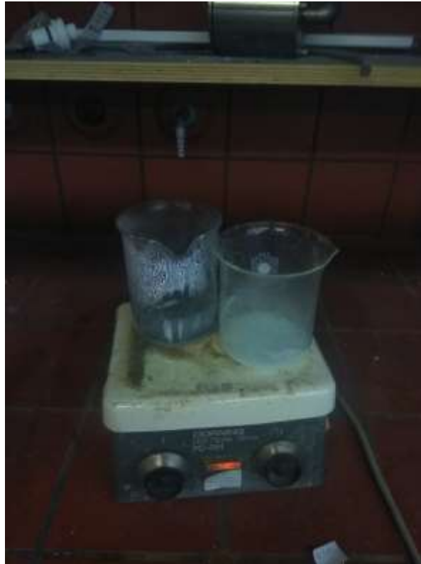
Εικόνα 32. Αριστερά Mo σε αλούμινα, δεξιά Cu-Mo σε αλουμινα, με την μέθοδο υγρού εμποτισμού, σε t=1h
