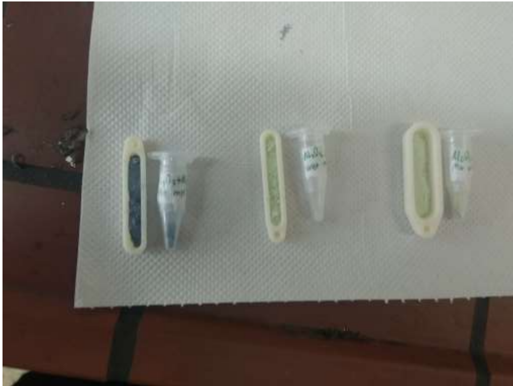
Εικόνα 33. Από αριστερά προς τα δεξιά: Mo, Cu, Cu-Mo σε αλούμινα, με την μέθοδο υγρού εμποτισμού (λειοτριημένα)
