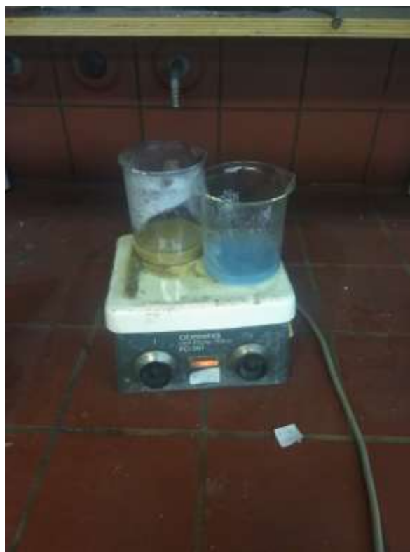
Εικόνα 31. Αριστερά Mo σε αλούμινα , δεξιά Cu-Mo σε αλουμινα, με την μέθοδο υγρού εμποτισμού, σε t=10 min
