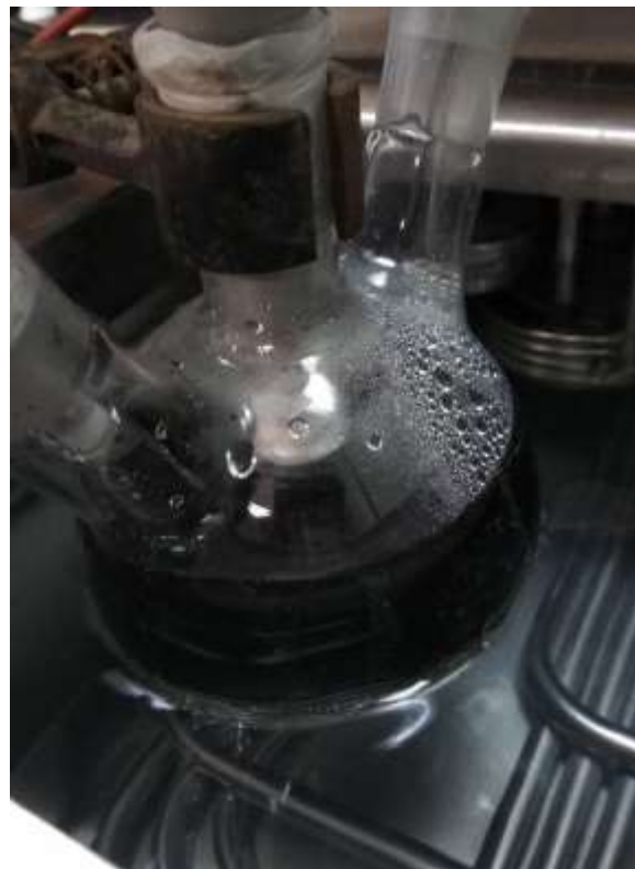
Εικόνα 41. Σύνθεση νανοσωματιδίων πλατίνας και ταυτόχρονη εναπόθεση τους σε ενεργό άνθρακα
