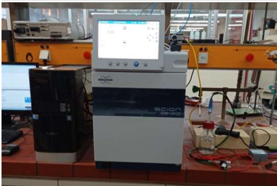
Εικόνα 19. Αεριοχρωματογράφος Scion-436 της Bruker
