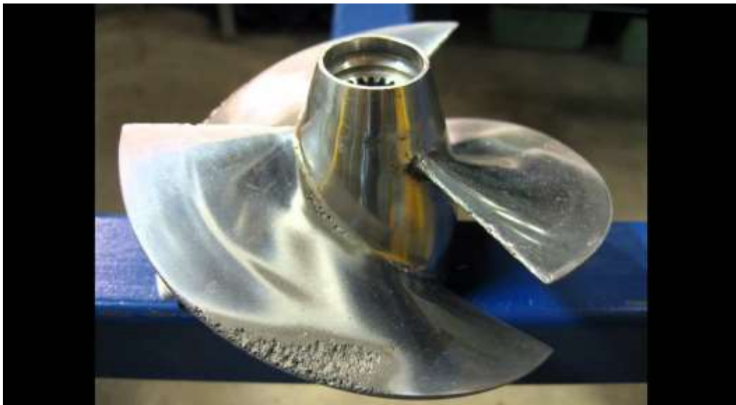
Εικόνα 12. Ζημιά σε προπέλα λόγω ακουστικής σπηλαιώσης
