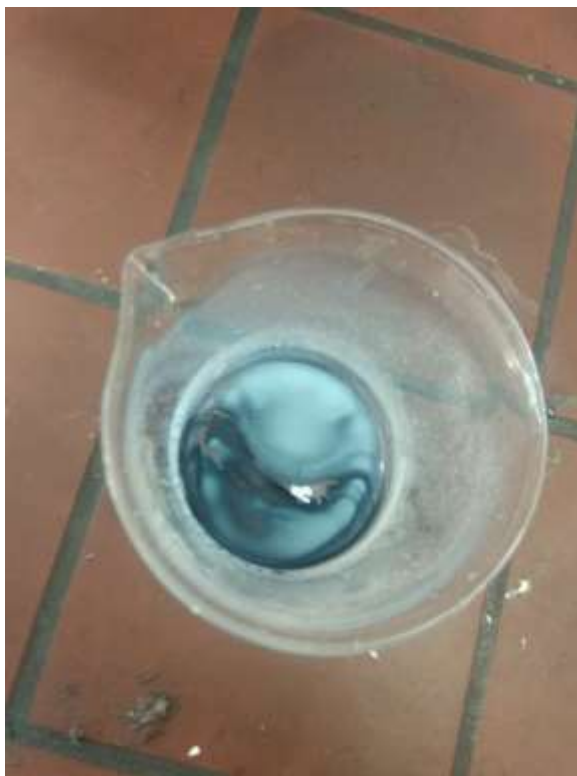
Εικόνα 29. Δείγμα εναπόθεσης Mo σε αλούμινα, με την μέθοδο υγρού εμποτισμού, πριν τη λειοτρίβιση
