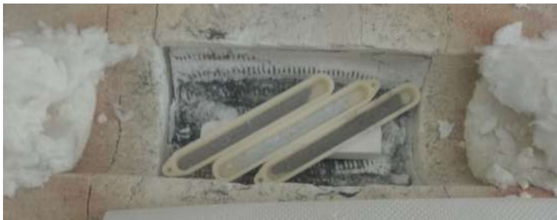
Εικόνα 35. Από αριστερά προς τα δεξιά: Cu, Mo, Cu-Mo σε αλούμινα, με ηχοχημική μέθοδο
