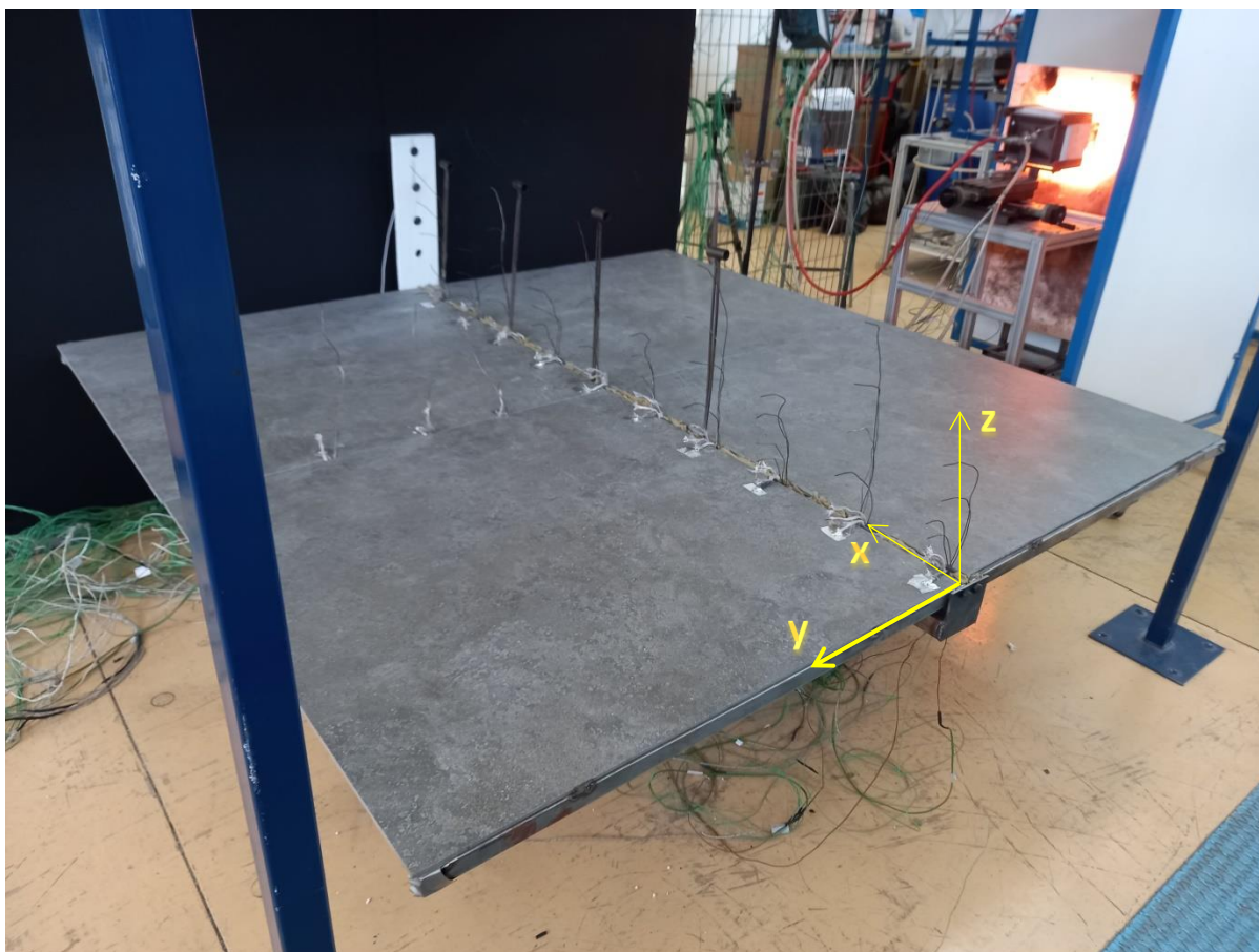
Σχήμα 4.2 Κλίνη καυσίμου στο Εργαστήριο Ετερογενών Μειγμάτων και Συστημάτων Καύσης στο Εθνικό Μετσόβιο Πολυτεχνείο. Σημειώνεται η αρχή των αξόνων.
