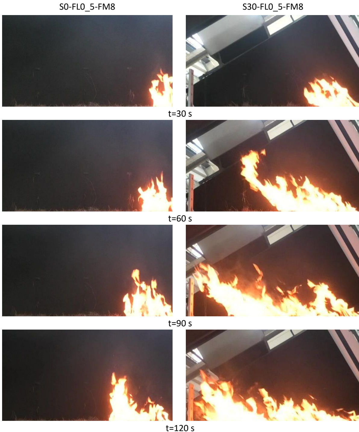
Σχήμα 5.19 Στιγμιότυπα εξέλιξης του φαινομένου για τα πειράματα S0-FLO_5-FM8 και S30-FLO_5-FM8 για διάφορες χρονικές στιγμές.
