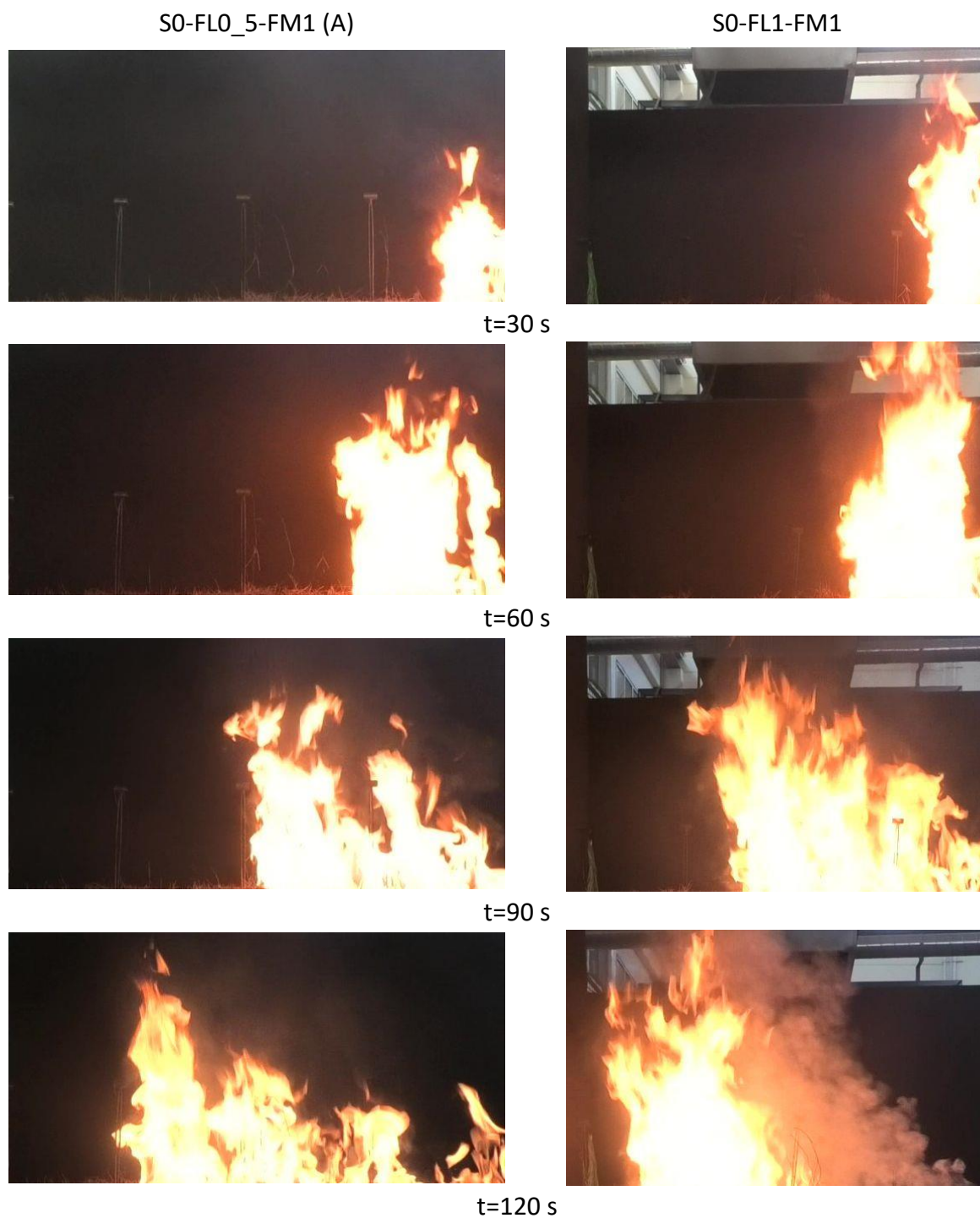
Σχήμα 5.14 Στιγμιότυπα εξέλιξης του φαινομένου από την οπίσθια κάμερα για τα πειράματα S0-FLO_5-FM1 (A) και S0-FL1-FM1 για διάφορες χρονικές στιγμές.
