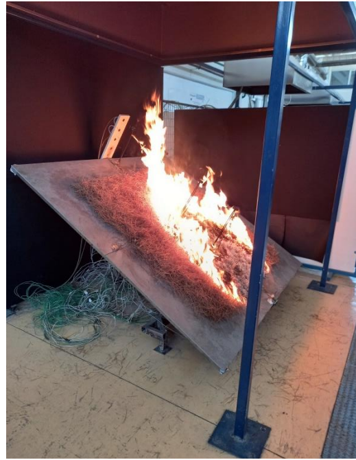
Σχήμα 5.2 Στιγμιότυπα της φωτιάς κατά τη διάρκεια των πειραμάτων. Αριστερά από το Πείραμα 9 (S20-FLO_5-FM8 (C)) και δεξιά από το Πείραμα 10 (S30-FLO_5-FM8).
