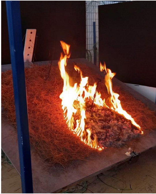
Σχήμα 5.2 Στιγμιότυπα της φωτιάς κατά τη διάρκεια των πειραμάτων. Αριστερά από το Πείραμα 9 (S20-FLO_5-FM8 (C)) και δεξιά από το Πείραμα 10 (S30-FLO_5-FM8).
