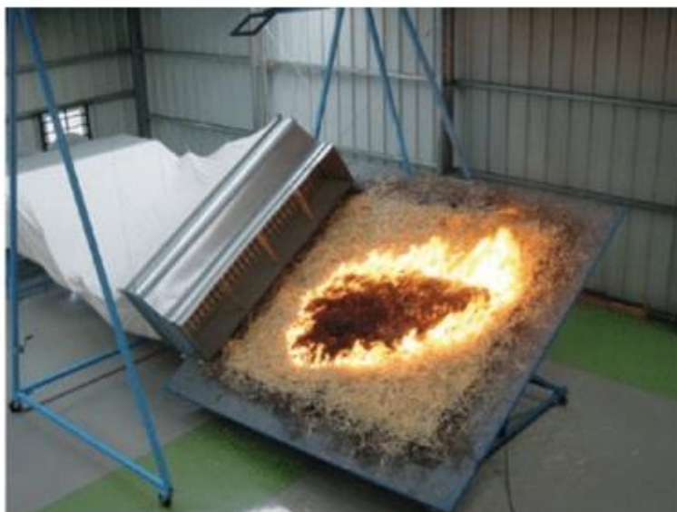
Σχήμα 2.8 Εργαστηριακή κλίνη καυσίμου υπό κλίση και με παροχή ρεύματος αέρα στο ένα της άκρο στο Πανεπιστήμιο Coibra της Πορτογαλίας.
