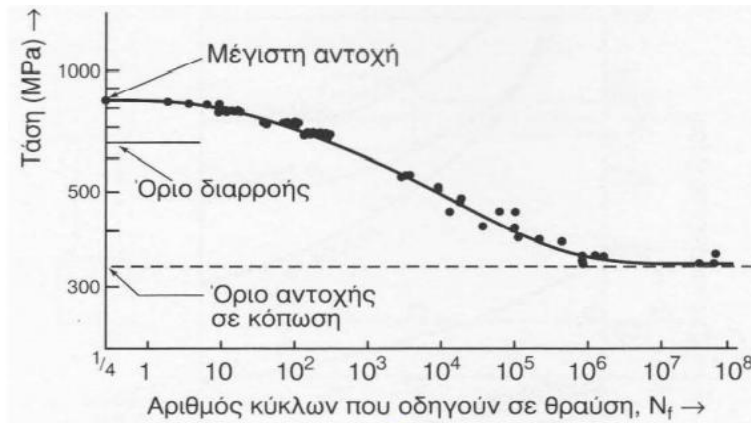
Σχήμα 10: Παράδειγμα καμπύλης Wohler με σημειωμένα τα μηχανικά χαρακτηριστικά του υλικού
