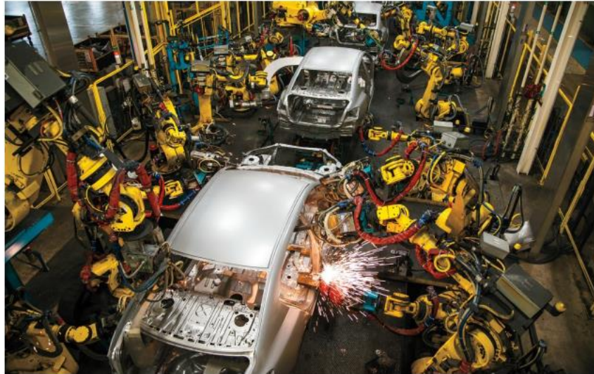
Εικόνα 2: Γραμμή συναρμολόγησης αμαξωμάτων της ιαπωνικής εταιρείας Ford (πηγή: Φωκάς, 2015)
