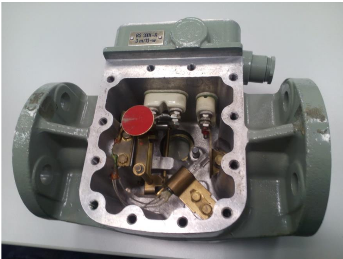
Εικόνα 2.20: Relay Προστασίας RS2001 με αποσπασμένο το εξωτερικό του κάλυμμα για να είναι ορατές οι επαφές του.
