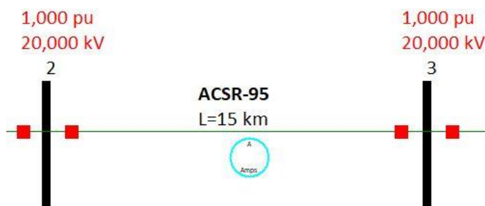
Εικόνα 4.6: Γραμμή διανομής MT ACSR-95, μήκους L = 15 km .
