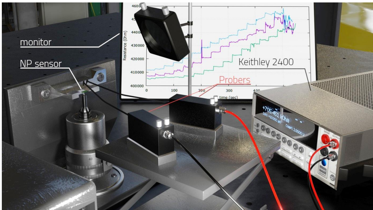
Εικόνα 13: Σύστημα χαρακτηρισμού αισθητήρων (στατική παραμόρφωση)
