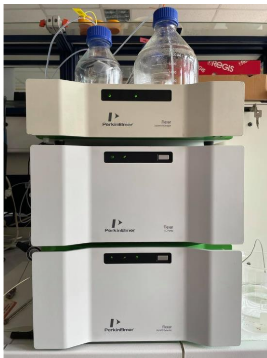
Εικόνα 12. Υγροχρωματογραφικό σύστημα Flexar (Perkin Elmer)
