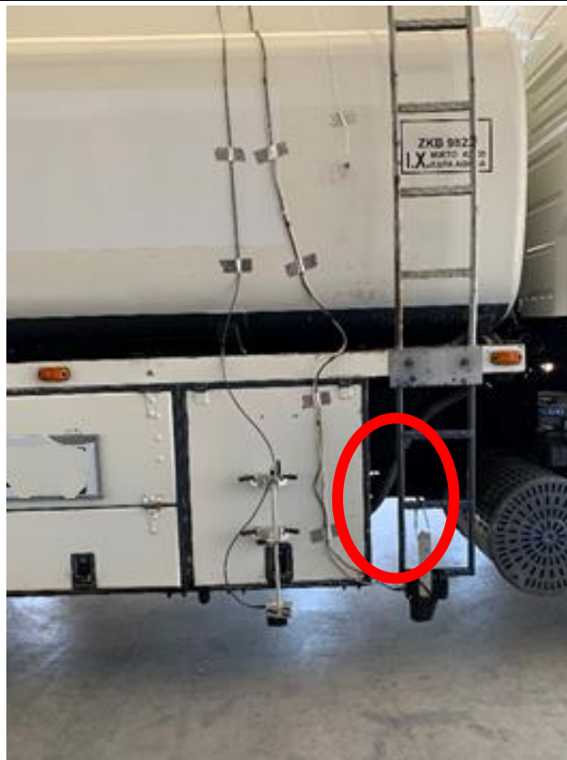
Σχήμα 1-2. Θέσεις αισθητήρων στο τριαξονικό βυτιοφόρο όχημα
