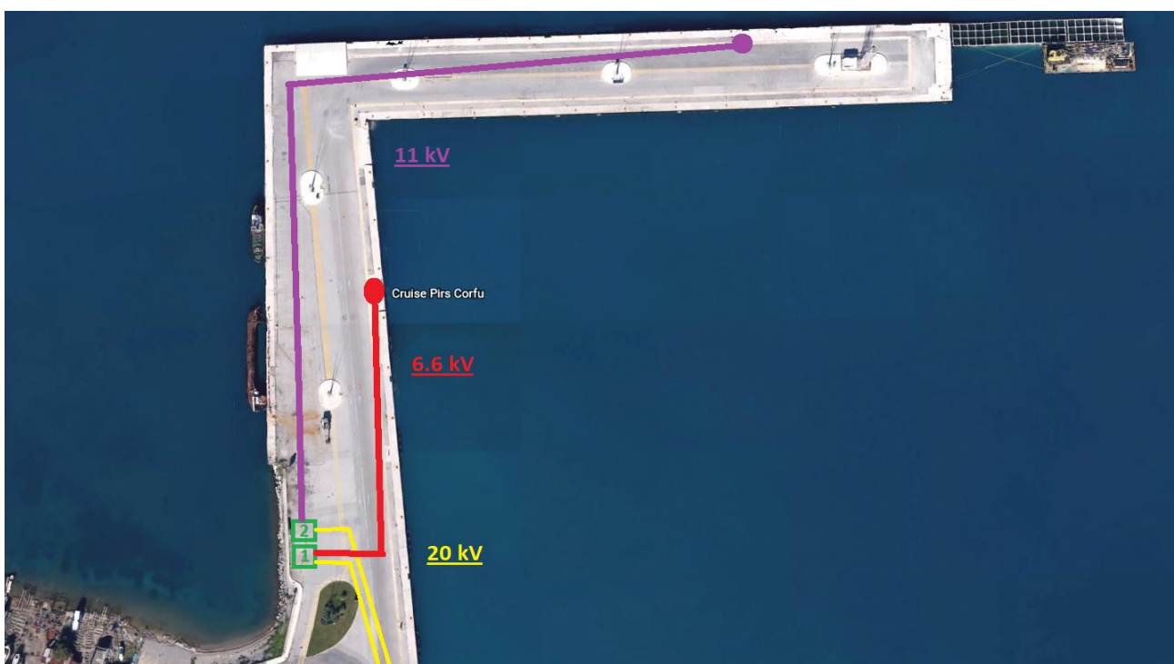
Εικόνα 5.19 Εγκατάσταση 1 ου και 2 ου σημείου ελλιμενισμού, υποσταθμού και καλωδιώσεων για κρουαζιερόπλοια
