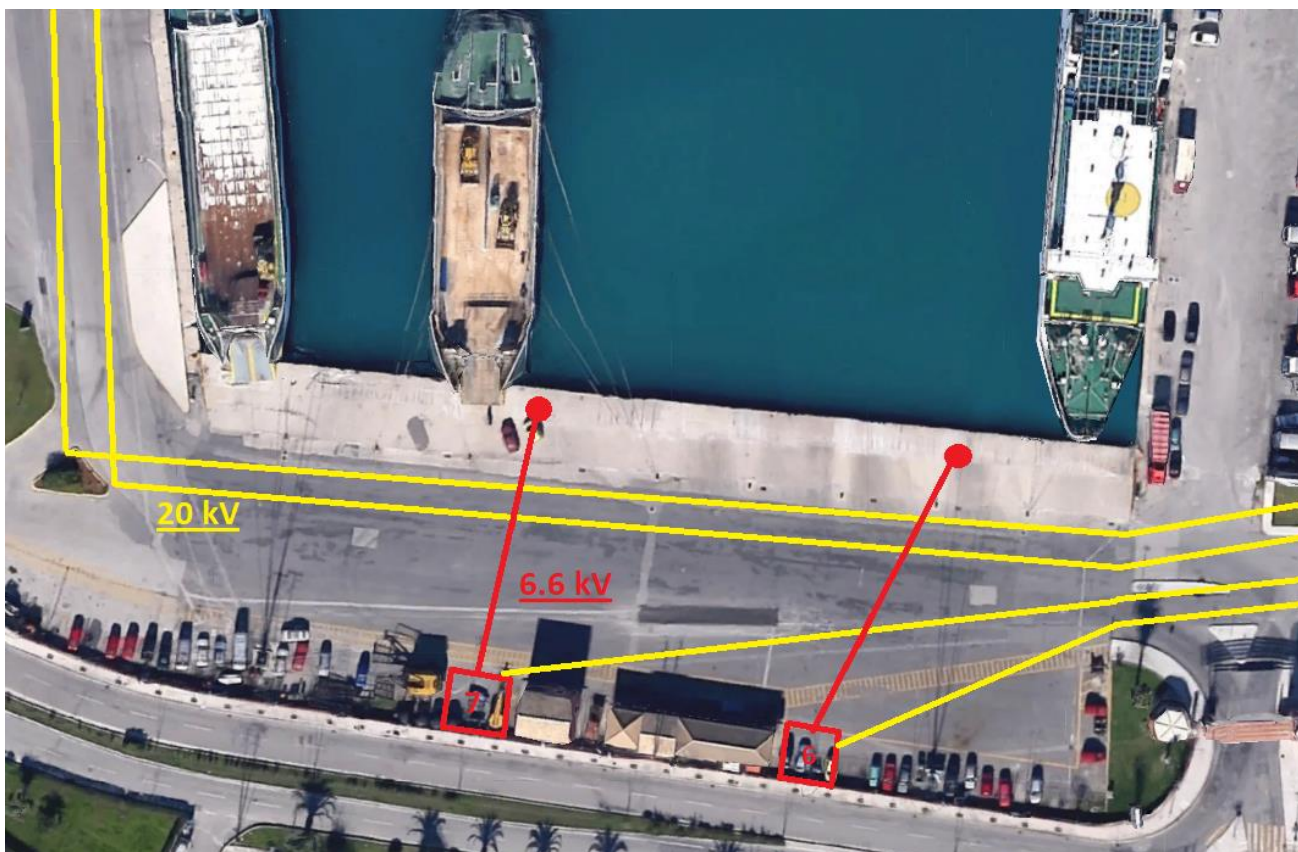
Εικόνα 5.18 Εγκατάσταση 6 ου και 7 ου σημείου ελλιμενισμού, υποσταθμού και καλωδιώσεων για οχηματαγωγά πλοία
