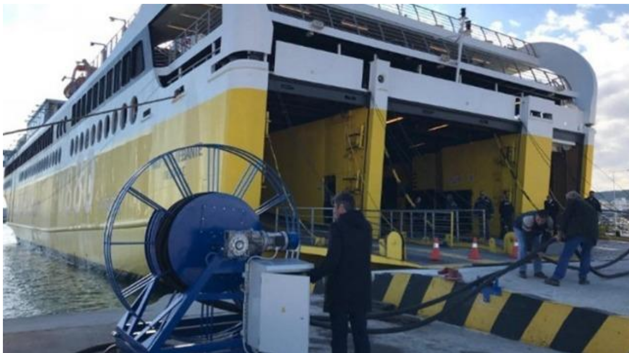
Εικόνα 3.1 Σύνδεση του επιβατηγού οχηματαγωγού Fior Di Levante με το λιμάνι της Κυλλήνης με τη μέθοδο Cold Ironing [3]
