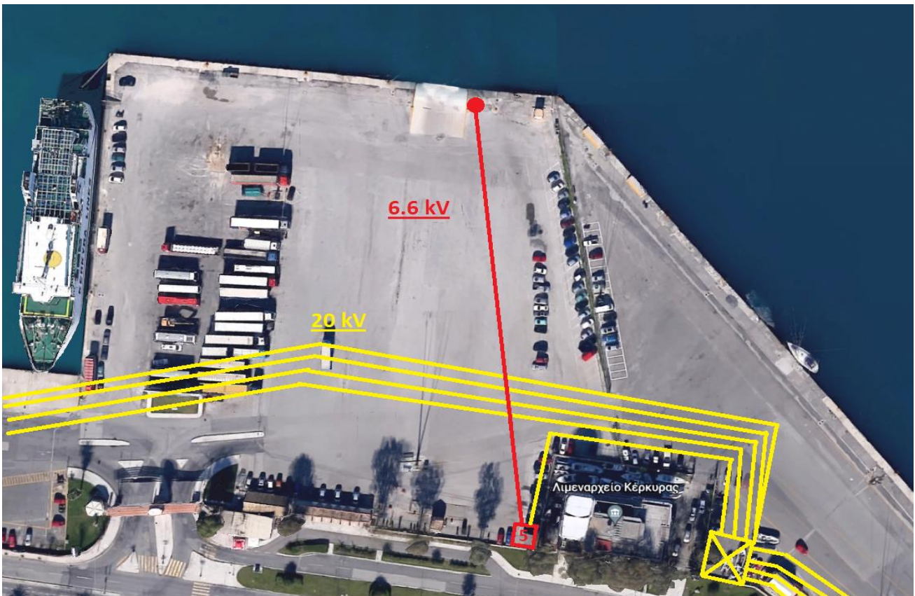
Εικόνα 5.17 Εγκατάσταση κύριου υποσταθμού και 5ου σημείου ελλειμενισμού, υποσταθμού και καλωδιώσεων για οχηματαγωγά πλοία
