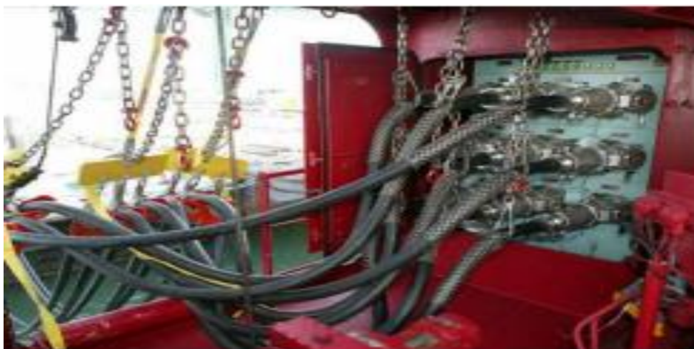
Εικόνα 24: Σύστημα σύνδεσης καλωδίων πάνω στο πλοίο (AAPA, 2007)
