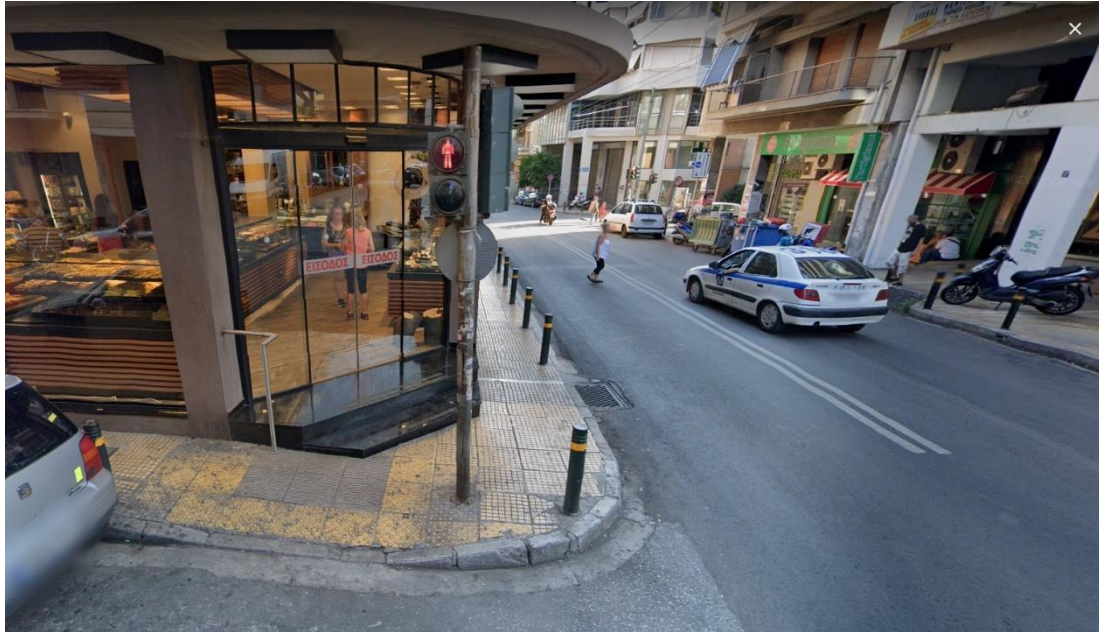
Σχήμα 66 - Φανάρι εμποδίζει τη διέλευση ( E3=0 ), Πηγή: Google Street View, 2019.
