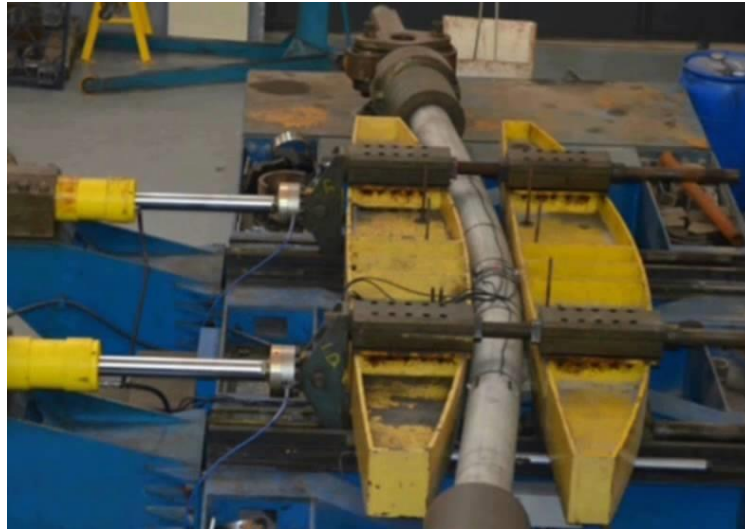
Σχήμα 3.12: Διαδικασία επαναφοράς αγωγού στην ευθύγραμμη μορφή του.
