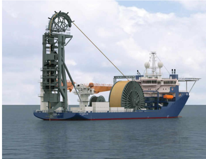
Σχήμα 3.11: Διαμόρφωση σκάφους που ακολουθεί την ρίψη με την κατακόρυφη μέθοδο Reel-lay.
