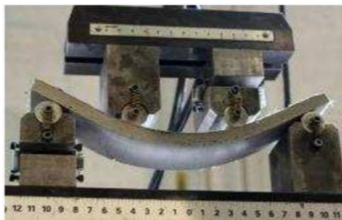
Σχήμα 3.22: Πειραματική διαδικασία κάμψης σκυροδέματος.
