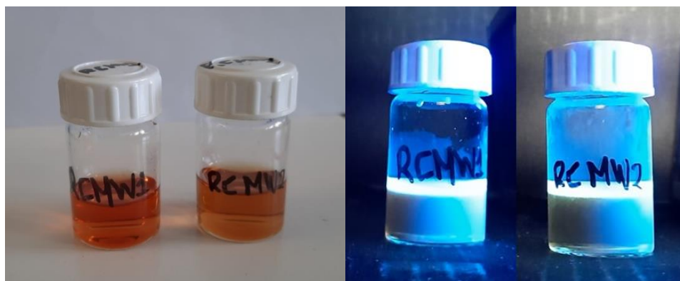
Εικόνα 4.10. Έκθεση RCMW1 και RCMW2 σε ορατό φως και σε υπεριώδες φως 365 nm.
