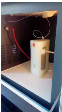
Εικόνα 4.4. Εισαγωγή του διαλύματος σε ειδικό δοχείο Teflon και προσαρμογή αυτού στον αντιδραστήρα μικροκυμάτων.
