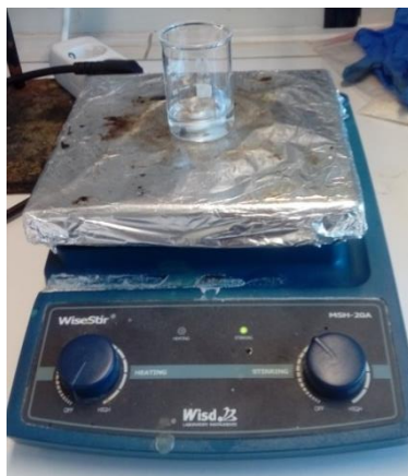
Εικόνα 4.3. Διαλυτοποίηση κιτρικού οξέος και ουρίας σε απιονισμένο νερό με μαγνητική ανάδευση.
