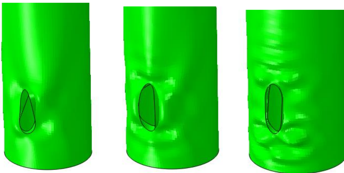
Σχήμα 4.6 : 1 η , 2 η και 5 η Ιδιομορφή κελύφους με ενισχυτικό πλαίσιο πλάτους 400 m
