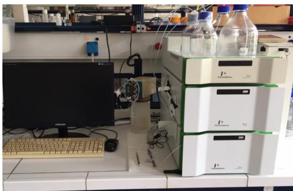
Εικόνα 14: Το χρωματογραφικό σύστημα συνδεδεμένο με τον υπολογιστή
