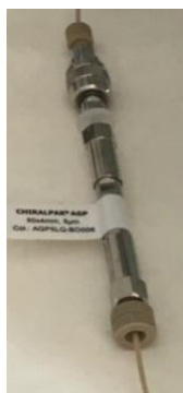
Εικόνα 15: Στήλη ακινητοποιημένης \alpha_1 όξινης γλυκοπρωτεΐνης
