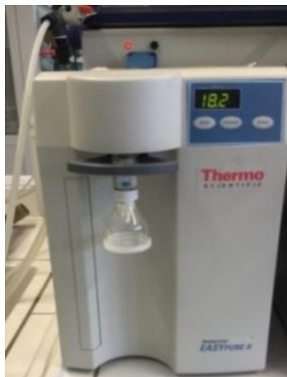
Εικόνα 16: Συσκευή παραγωγής υπερκάθαρου νερού
