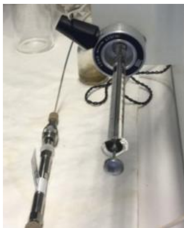
Εικόνα 17: Σύστημα εισαγωγής του δείγματος στη στήλη
