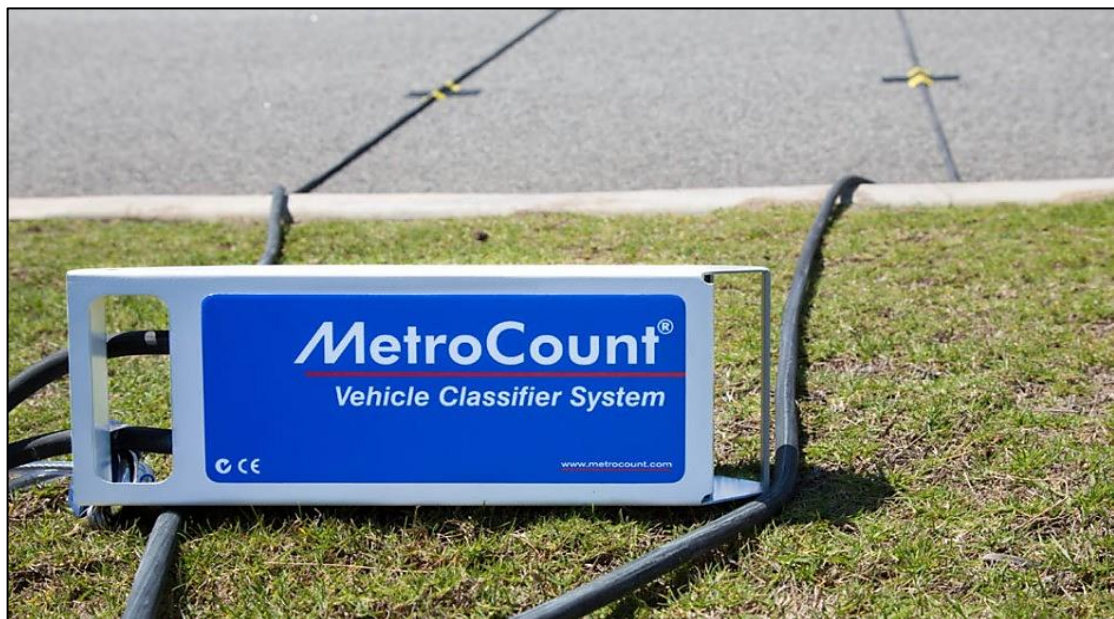
Σχήμα 3.29: Λαστιχένιοι σωλήνες καταγραφής κυκλοφοριακών μεγεθών MC5600, MetroCount ( https://metrocount.com/?attachment_id=4246 )
