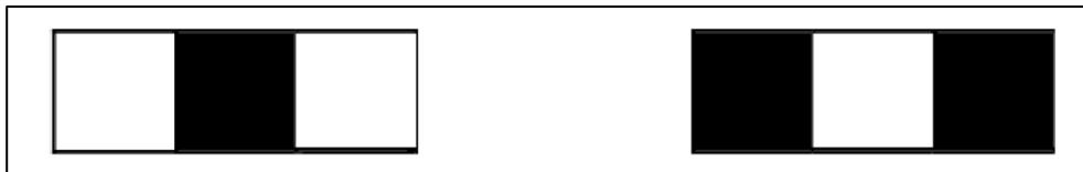
Σχήμα 8.4: Μη αποδεκτές ακολουθίες εικονοστοιχείων.
