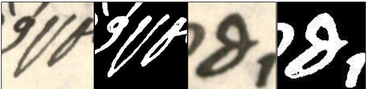
Σχήμα 7.16: Εικόνες εισόδου και εξόδου δυο γραμμάτων του αλγορίθμου κατάτμησης δυο γραμμάτων, από το χειρόγραφο του προς μελέτη συγγράμματος «Δοκιμασμένη φιλία».
