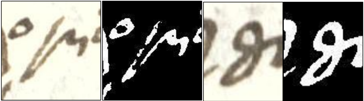
Σχήμα 7.14: Εικόνες εισόδου και εξόδου δυο γραμμάτων του αλγορίθμου κατάτμησης δυο γραμμάτων, από το χειρόγραφο του προς μελέτη συγγράμματος «Φυσικής Απάνθισμα »
