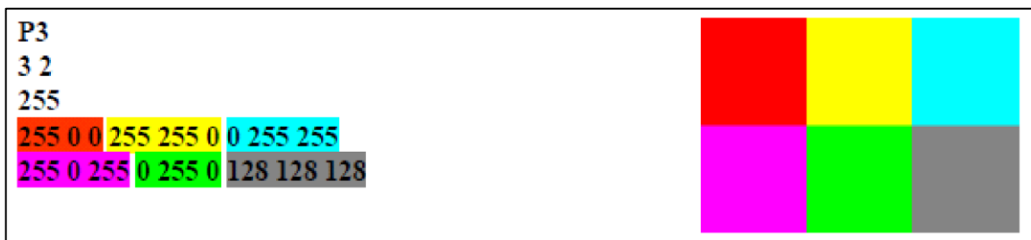
Σχήμα 3.2: Αναπαράσταση χρωματικής πληροφορίας σε μορφότυπο .ppm, εικόνας 2X3 εικονοστοιχείων [18].
