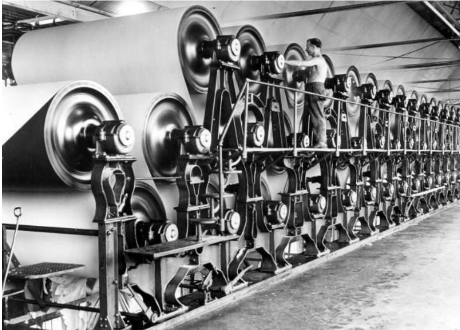
Εικόνα 1.2-3 : Κύλινδροι ξήρανσης χαρτιού σε χαρτοποιητική μηχανή (περ. 1970). Wikimedia Commons, .Public Domain.
