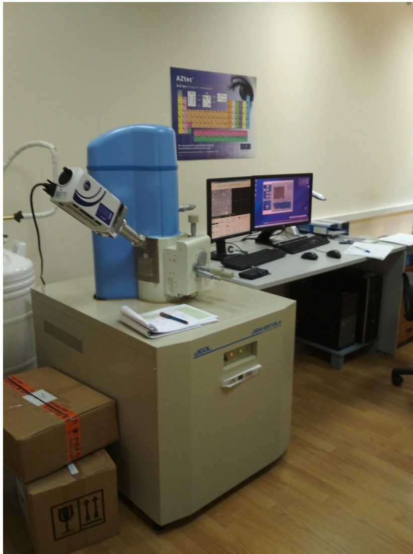
Εικόνα 12.2-22: Ηλεκτρονικό Μικροσκόπιο Σάρωσης (Scanning Electron Microscope, SEM), μοντέλο JSM 6510-LV της εταιρείας JEOL.
