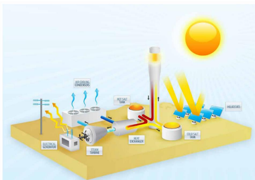
Εικόνα 2-2: Διάταξη τυπικού σταθμού CSP Πηγή: https://skepticalscience.com/Zero-Carbon-Australia-2020.html
