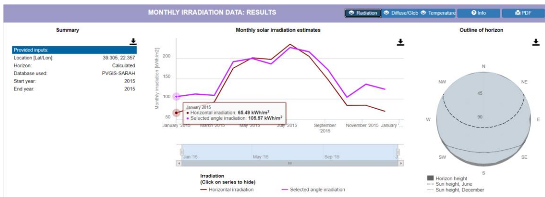
Εικόνα 5-13 Διαγραμματική απεικόνιση ακτινοβολίας σε οριζόντιο επίπεδο και σε επίπεδο 30ο για το έτος 2015
