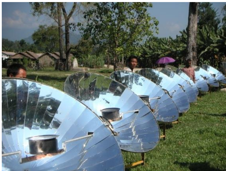
Σχήμα 3.3 Δείγματα ηλιακών συσσωρευτών. Μια κατσαρόλα με νερό τοποθετείται σε μια προεξοχή στο κέντρο των παραβολικών επιφανειών για να εκμεταλλευτεί πλήρως τις ακτίνες του ήλιου.
