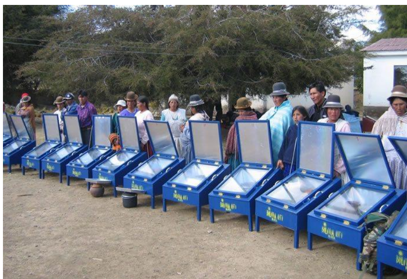
Σχήμα 3.1 Ηλιακές εστίες, Φτιαγμένες στη Βολιβία, ξύλινες με κεκλιμένο κάλυμμα και ανακλαστήρα στο καπάκι
