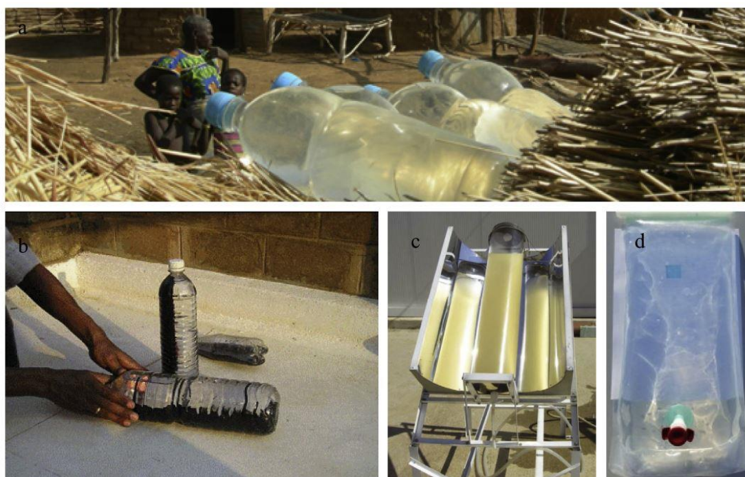
Σχήμα 3.9 Απεικόνιση (α) μέθοδος ηλιακής απολύμανσης με έκθεση του νερού στο ηλιακό φως στις σκεπές των σπιτιών (β) χρωματισμός των μπουκαλιών για καλύτερη απορρόφηση της ηλιακής ακτινοβολίας (c) σύστημα παραβολικού συλλέκτη για ηλιακή παστερίωση του νερού που περιέχεται σε διαφανή σωλήνα (d) σύστημα ηλιακής παστερίωσης με το νερό τοποθετημένο σε διαφανή σάκο
