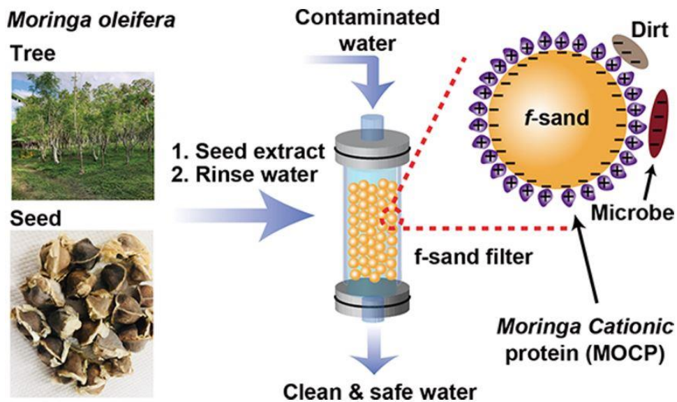
Σχήμα 5.3 Φίλτρα άμμου Moringa oleifera f-sand για βιώσιμο καθαρισμό νερού
