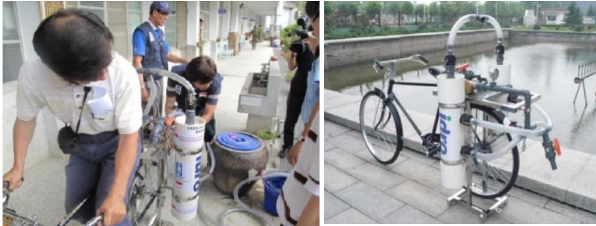
Σχήμα 4.11 Θύματα τυφώνα στην Ταϊβάν χρησιμοποιούν τη δύναμη του ποδηλάτου για να φιλτράρουν το νερό τους
