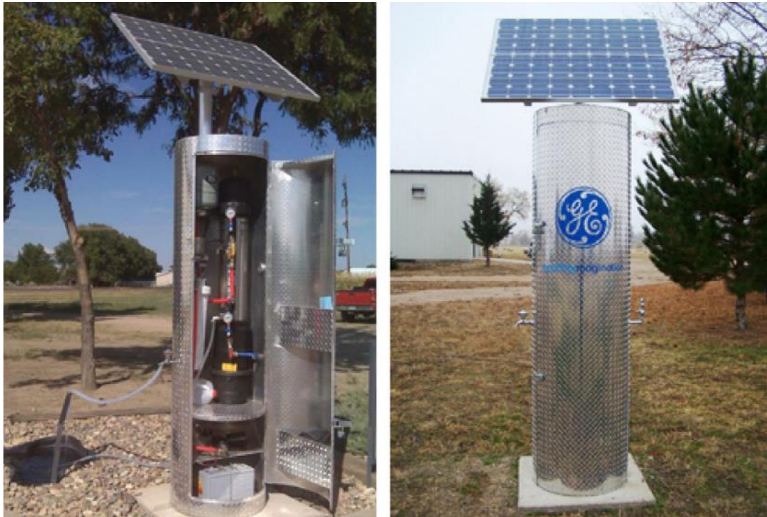
Σχήμα 4.8 Το Sunspring χρησιμοποιεί ηλιακούς συλλέκτες για να τροφοδοτεί την αντλία του και να επεξεργάζεται το νερό
