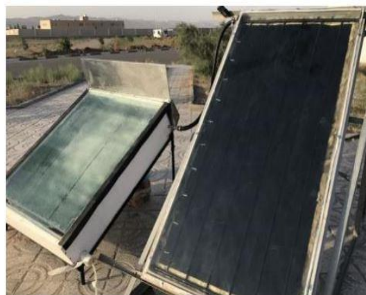
Σχήμα 3.17 Εφαρμογές συστημάτων ηλιακών αποστακτηρών μονής κλίσης ενσωματωμένοι με (αριστερά) ηλιακό συλλέκτη εκκενωμένου σωλήνα και (δεξιά) συλλέκτη επίπεδης πλάκας
