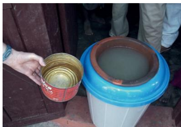
Σχήμα 4.5 Αναπαράσταση κεραμικού φίλτρου δοχείου και δεξιά σύγκριση του μη επεξεργασμένου νερού και του καθαρού
