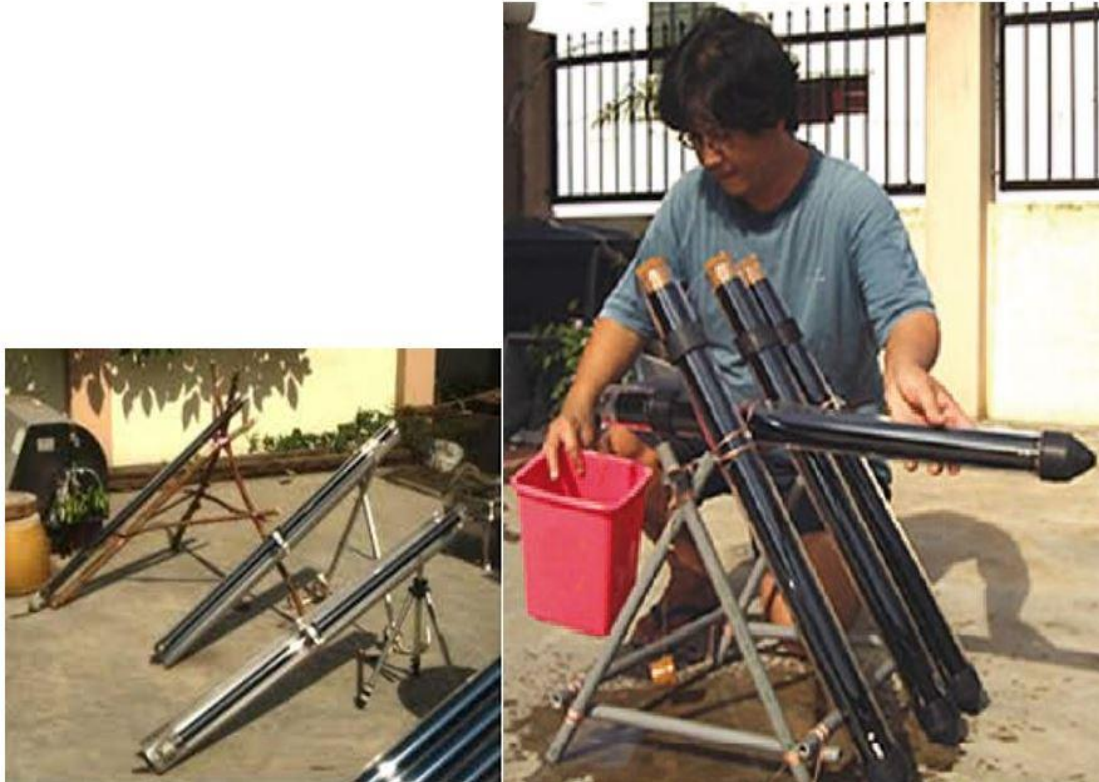
Σχήμα 3.5 Μια σειρά από ηλιακούς βραστήρες-φιάλη που περιστρέφονται για να χύσουν το παστεριωμένο νερό
