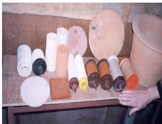
Σχήμα 4.4 Ενδεικτικά μεγέθη κεραμικών φίλτρων τύπου κεριού και διαθέσιμα συστήματα της εταιρείας Kisii (Dies,2003)
