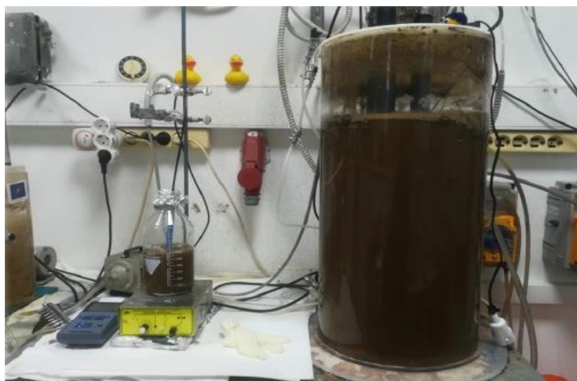
Εικόνα 4.2: Πειράματα μέτρησης ταχύτητας νιτροδοποίησης και απονιτροδοποίησης σε batch αντιδραστήρα χωρίς βιοφορείς (αριστερά) και στον αντιδραστήρα IFAS-SBR (δεξιά)
