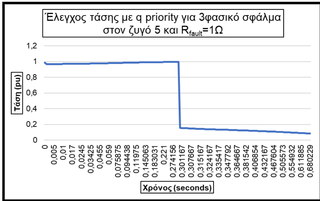
Διάγραμμα 9 : Έλεγχος τάσης με Q priority με όλες τις μονάδες σε λειτουργία
