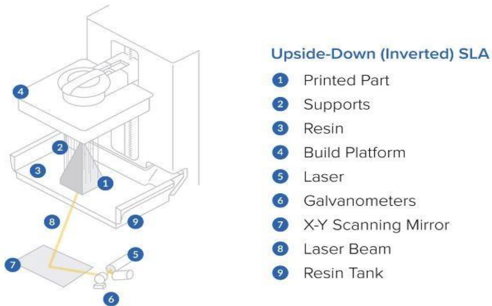
Σχήμα 16. Τμηματική διάταξη στερεολιθογραφικού τριδιάστατου εκτυπωτή. (59)
