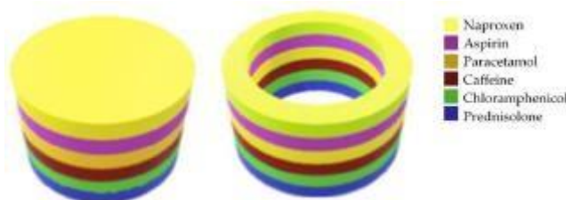
Σχήμα 27. Σχηματικό διάγραμμα του δισκίου πολλαπλών στιβάδων (Παρακεταμόλη, Καφεΐνη, Ακετυλοσαλικυλικό οξύ, Χλωραμφαινικόλη, Ναπροξένη, και Πρεδνιζολόνη) της Pamela Robles-Martinez και της ομάδας της (93)
