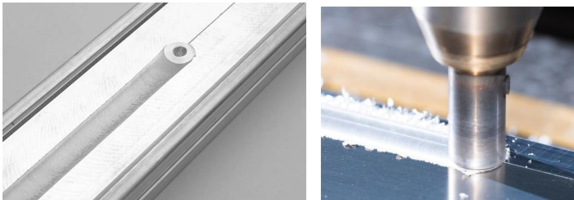
Εικόνα 2.5: Παραδείγματα ραφής από κατεργασία FSW [15], [16]
