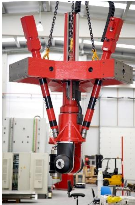
Εικόνα 1.3: Tricept robot της PKM [5]
