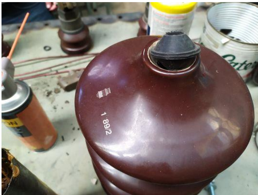
Εικόνα 43 Παρεμβύσματα στον ακροδέκτη υψηλής τάσης
