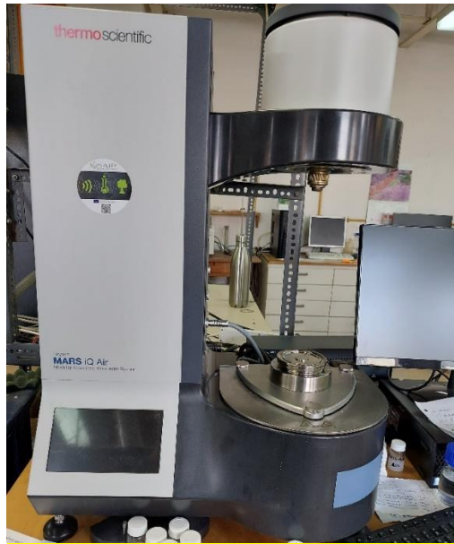
Εικόνα 26: Περιστρεφόμενο ροόμετρο με το οποίο έγιναν οι ρεολογικές αναλύσεις των δειγμάτων.
