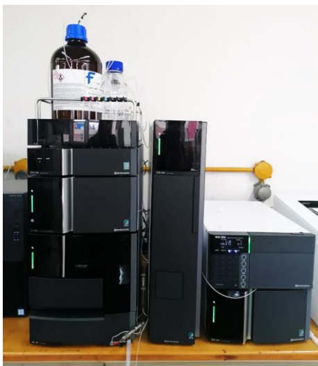
Εικόνα 25: Χρωματογράφος ηηκτόματος (GPC) με τον οποίο έγιναν οι αναλύσεις των δειγμάτων.
