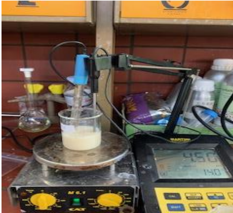
Εικόνα 13: πειραματική διαδικασία καταβύθισης πρωτεϊνών
