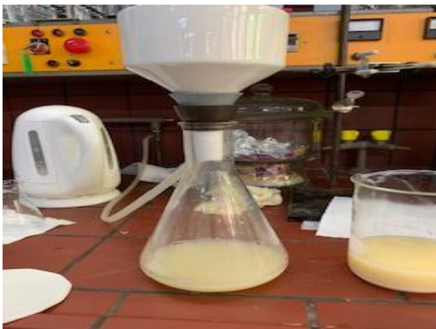
Εικόνα 12: πειραματική διαδικασία διήθησης
