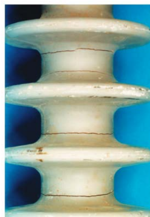
Σχήμα 1-12: Περιφερειακές Ρωγμές Εποξικού Περιβλήματος [20]
