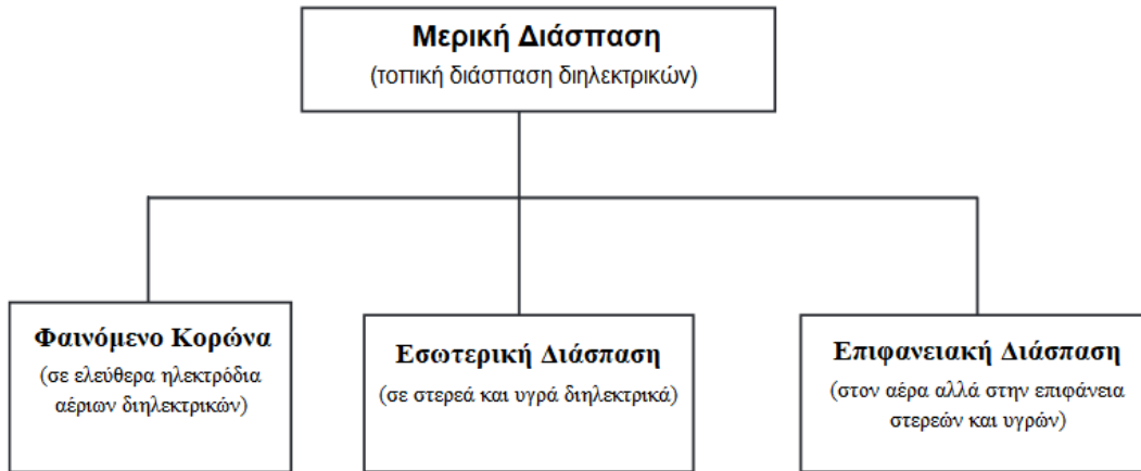
Σχήμα 2-2: Ταξινόμηση Μερικής Διάσπασης (Partial Breakdown-PB) [32]
