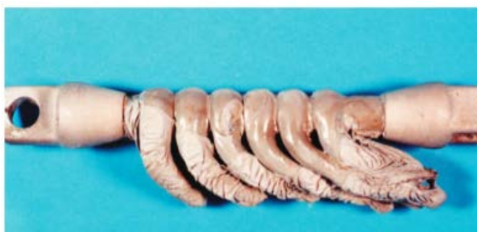
Σχήμα 1-11 : Υδρόλυση εποξικού περιβλήματος [20]
