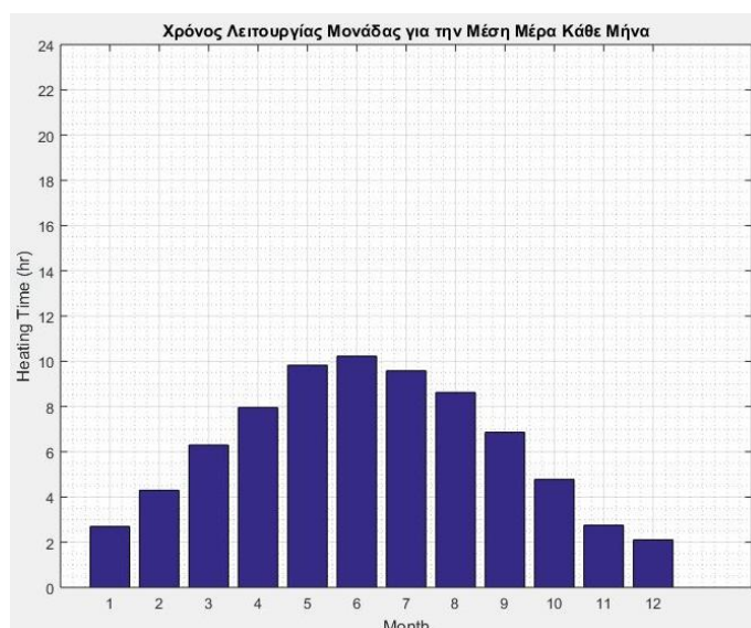
Διάγραμμα 6.3.1: Χρόνος λειτουργίας της μονάδας χωρίς ORC για την μέση ημέρα κάθε μήνα με καθαρό ουρανό και για τα δεδομένα ηλιοφάνειας και θερμοκρασίας της Αθήνας.
