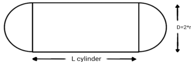
Εικόνα 4.1: Σκαρίφημα δεξαμενής υδρογόνου
