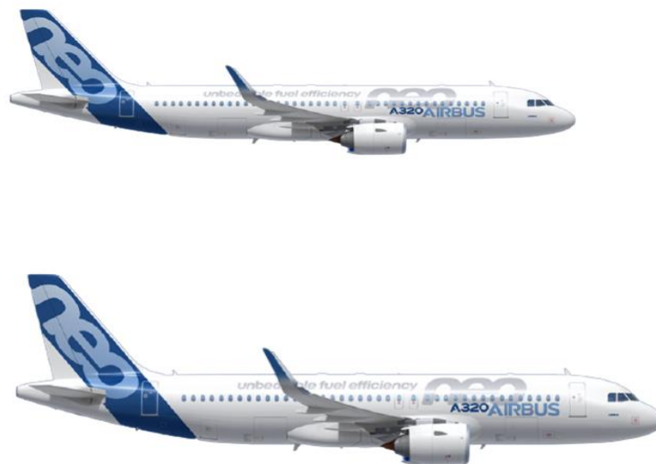
Εικόνα 4.2: Πλάγια όψη A320neo με καύσιμο Jet-A1 (πάνω σχήμα) και A320neo με καύσιμο υδρογόνο (κάτω σχήμα)
