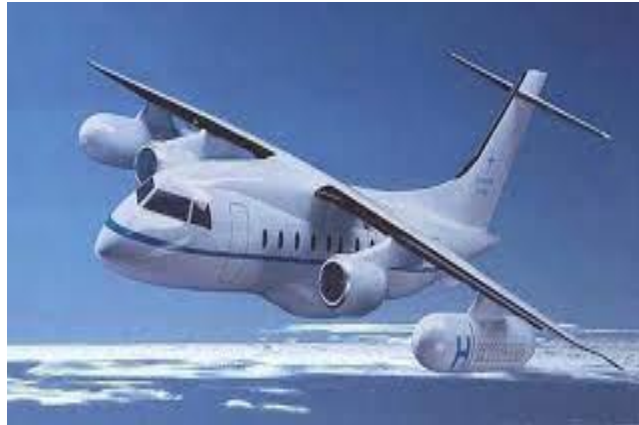
Εικόνα 2.7: Αποσπώμενες Δεξαμενές Υδρογόνου (Πηγή: [8])
