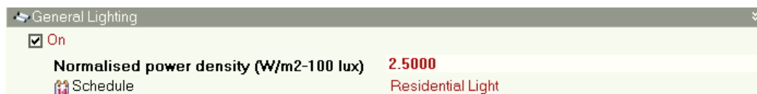
Εικόνα 3.28 Τυπικές τιμές πυκνότητας ισχύος φωτισμού ανά 100 lux
